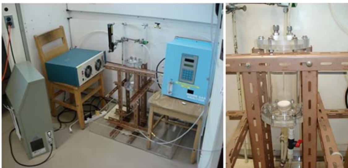
Figura 15 – Sistema de ozonização no interior da capela com detalhe do reator à direita.
