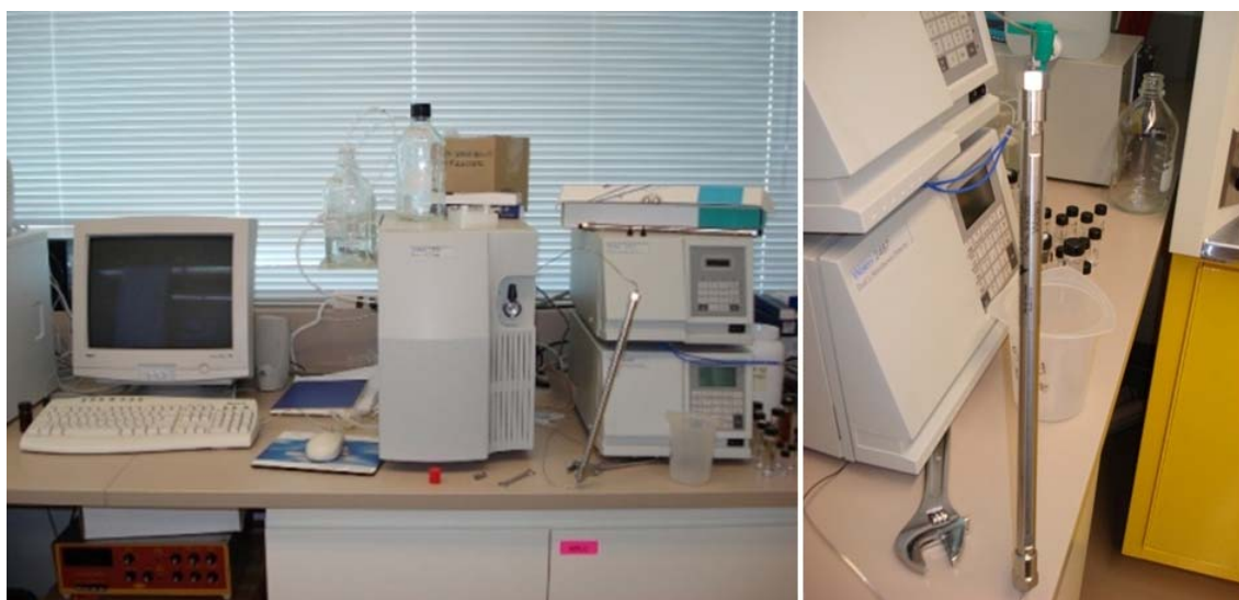
Figura 17 – Instrumentação para análise de HPSEC com detalhe para a coluna de separação.
