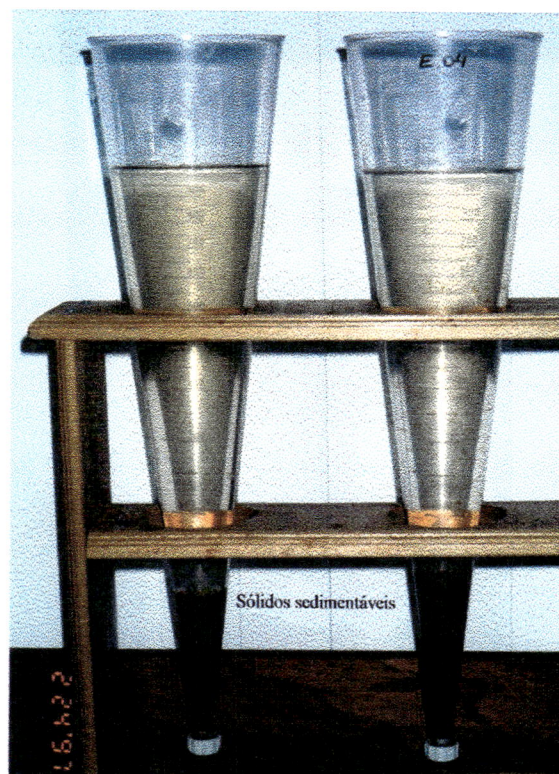
FIGURA 4.15 - Fotografia mostrando os Cones Imhoff de Sedimentação.
