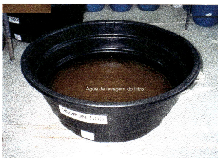
FIGURA 4.8 - Fotografia da caixa plástica utilizada para armazenar amostras da água de lavagem dos filtros, com capacidade para 500 litros.
