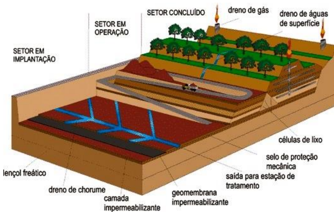
Figura 2 – Diagrama esquemático de um aterro sanitário. Fonte: IPT/CEMPRE (2000).
