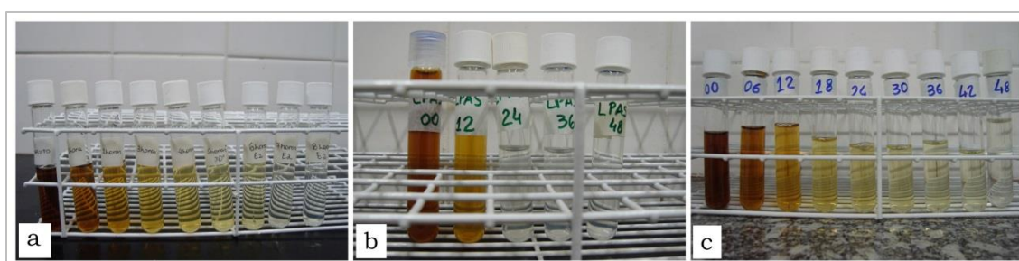
Figura 32- Alíquotas retiradas dos ensaios: (a) com lixiviado bruto no ensaio L4; (b) com lixiviado alcalinizado pré-tratado por air stripping no ensaio L9; e (c) com lixiviado bruto no ensaio L11.
