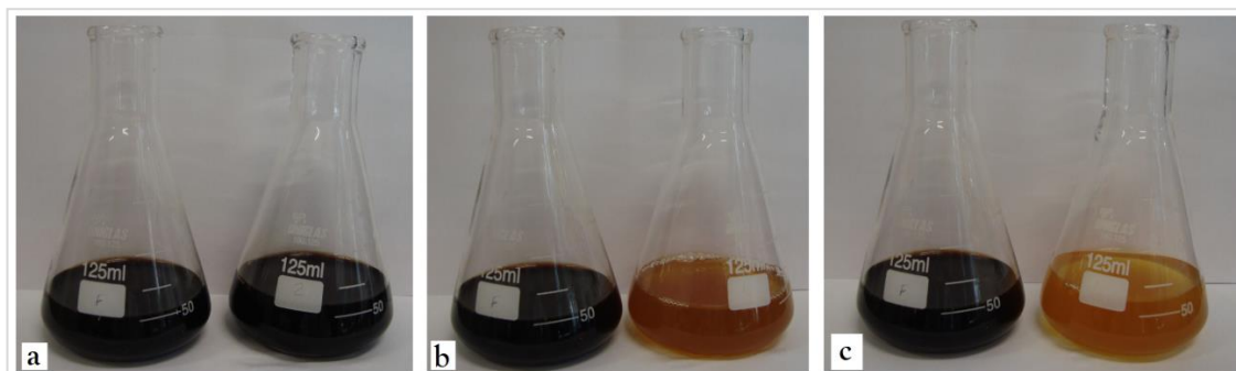
Figura 14 – Afluentes e efluentes ao processo eletroquímico, sendo que a imagem (a) se refere ao efluente sintético 1 com 3000 \text{ mg L}^{-1} de ácidos húmicos e 0 \text{ mg L}^{-1} de NaCl, a imagem (b) se refere ao efluente sintético 2 com 3000 \text{ mg L}^{-1} de ácidos húmicos e 1200 \text{ mg L}^{-1} de NaCl e a imagem (c) se refere ao efluente sintético 3 com 3000 \text{ mg L}^{-1} de ácidos húmicos e 3000 \text{ mg L}^{-1} de NaCl.
