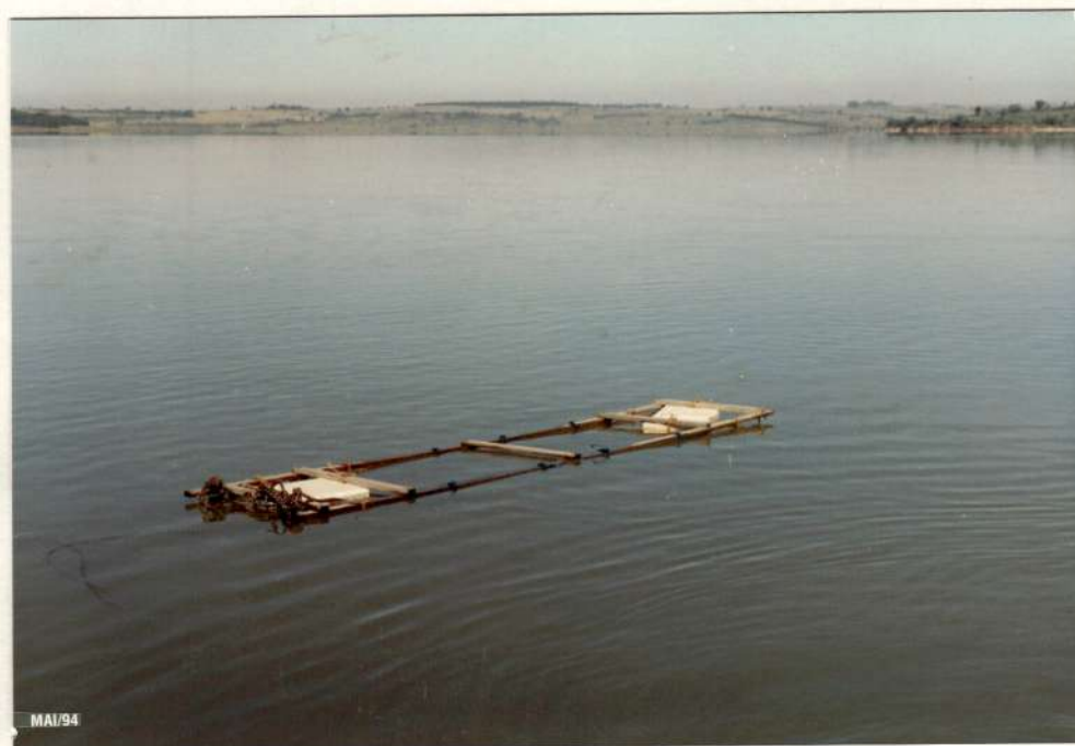
FIGURA 03 - Flutuador para a sustentação das câmaras de sedimentação na coluna d'água.
