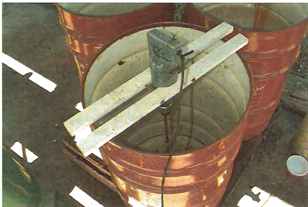
FIGURA 4.19 – Conjunto, tambor e agitador, adaptado para realizar a mistura da amostra composta.
