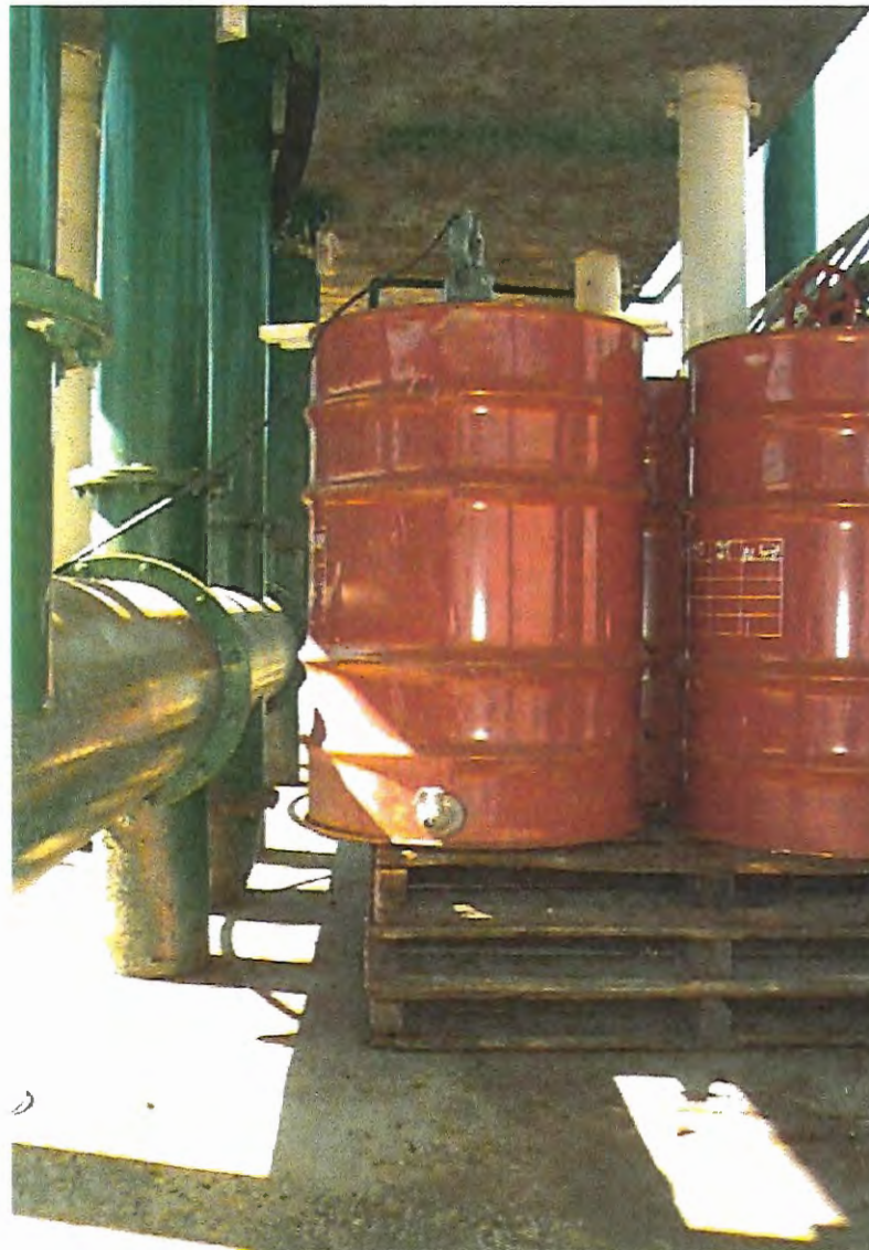
FIGURA 4.18 – Tambor adaptado para a mistura da amostra composta e simulação do processo de flotação da terceira fase.
