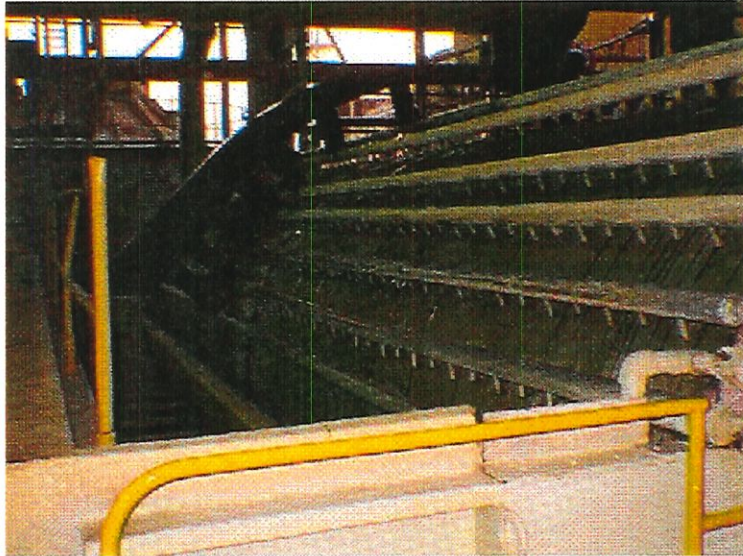
Figura 3.15. Aspecto de filtro lavador do tipo com perna barométrica utilizado na Jari Celulose.
