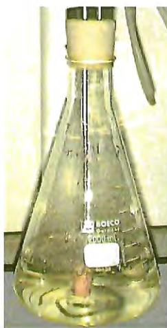
**FIGURA 18** – Sistema de coleta de gás em excesso (off-gas).
