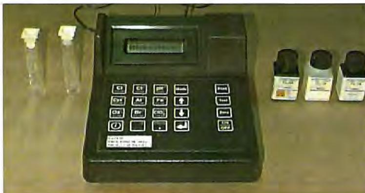
**FIGURA 19** – Espectrofotômetro Dulcotest, para determinação ozônio na fase líquida.
