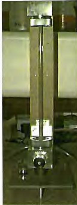
**FIGURA 16** – Rotâmetro, utilizador para regular vazão de gás.
