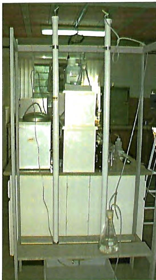
**FIGURA 17** – Coluna de ozonização, utilizada como câmara de contato. E sistema de coleta de “off-gas”, composto de um erlenmeyer, em série com a coluna.
