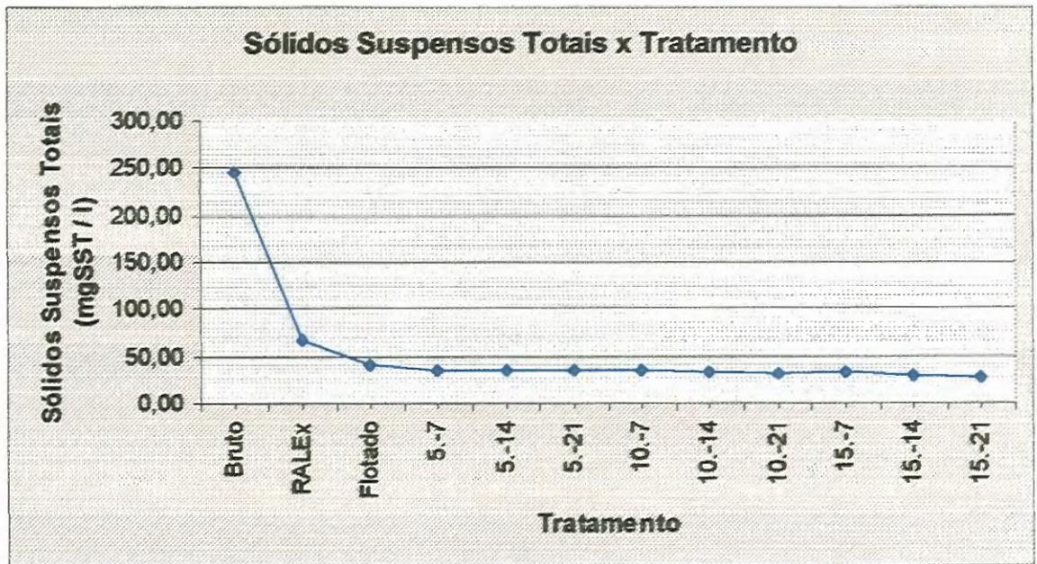
**FIGURA 30** – Evolução da concentração de sólidos suspensos totais, ao longo do sistema em estudo.
