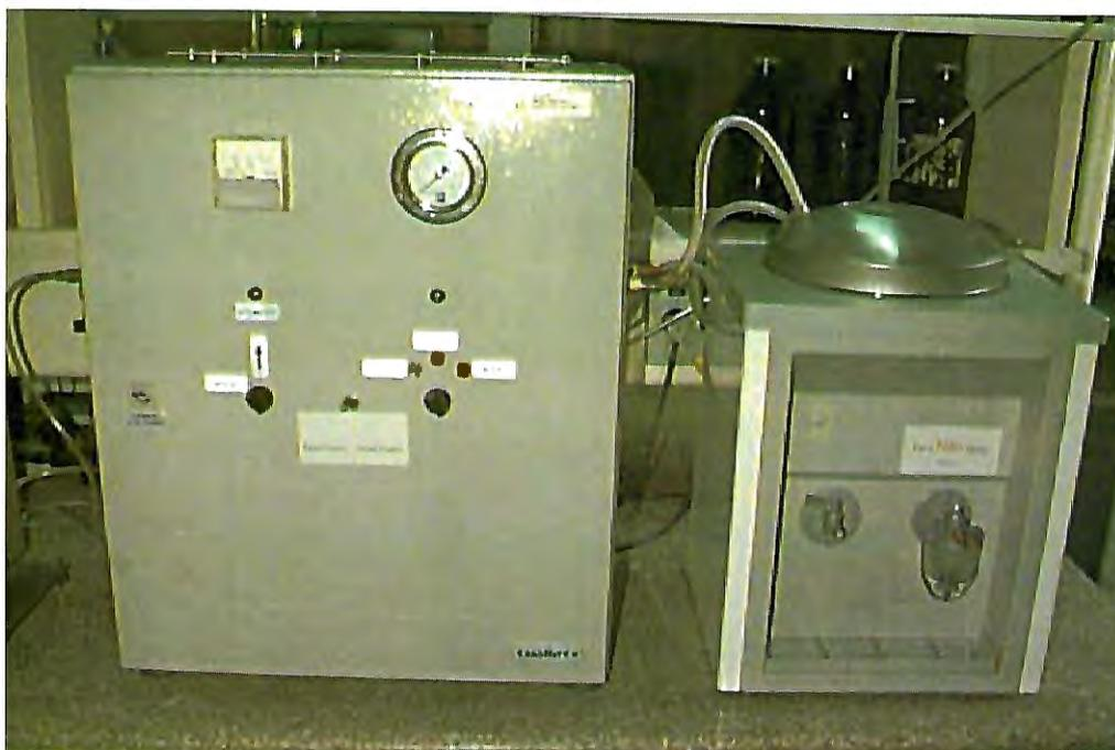
**FIGURA 15** – Gerador de ozônio Qualid'or – Laboratório à esquerda, e câmara refrigeradora à direita.
