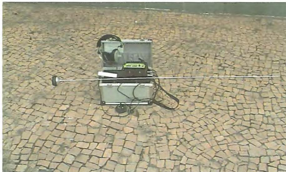
Figura 3.3: Geofone eletrônico e haste de escuta.
