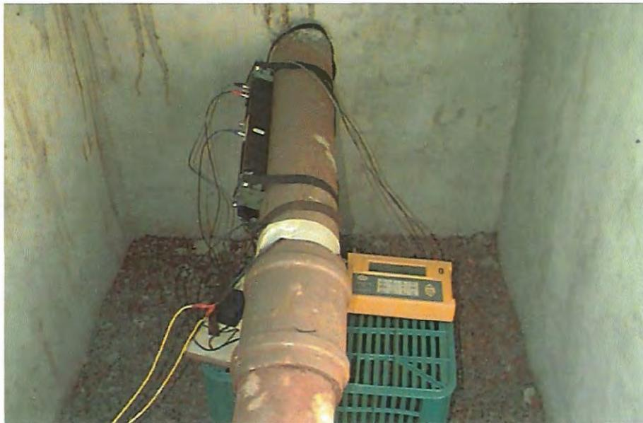
Figura 3.11: Medidor de vazão ultra-sônico não intrusivo.
