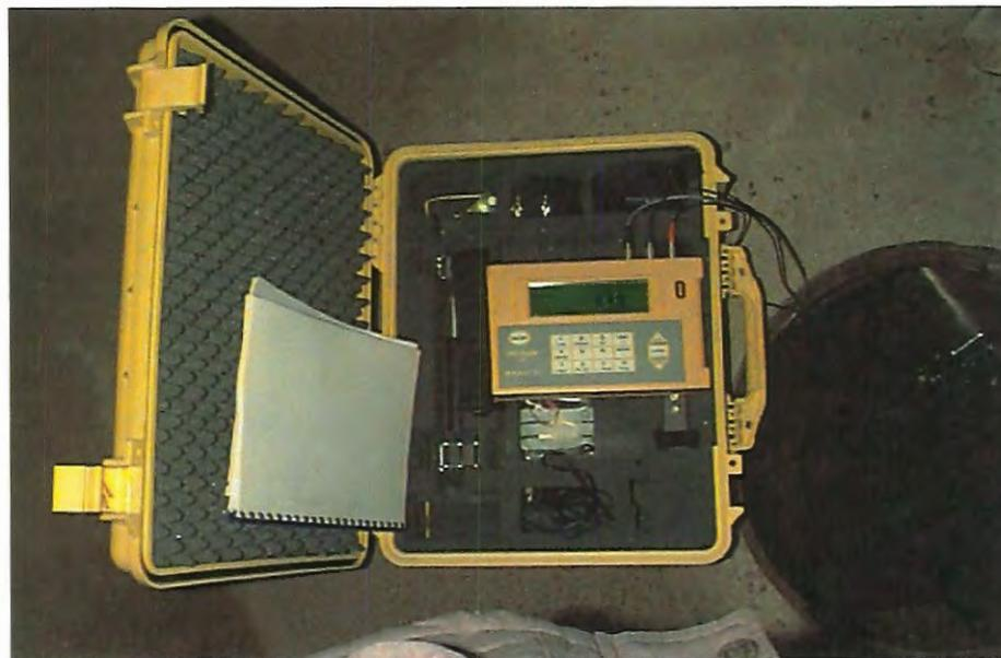
Figura 3.5: Medidor de vazão ultra-sônico não intrusivo modelo *Porta Flow 300*.
