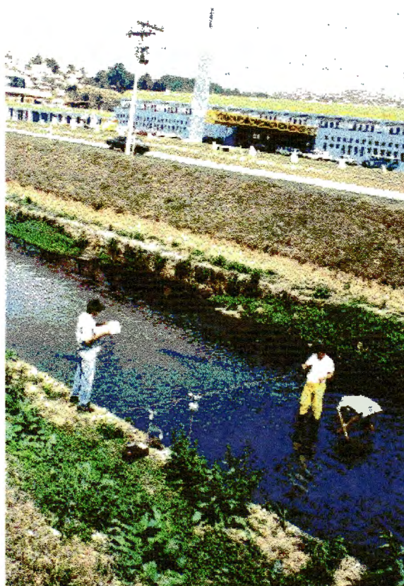
Figura 5.18 - Amostragem dos traçadores gasoso e fluorescente na seção 3 do canal urbano do Ribeirão de Caldas (Teste de 30/08/94).
