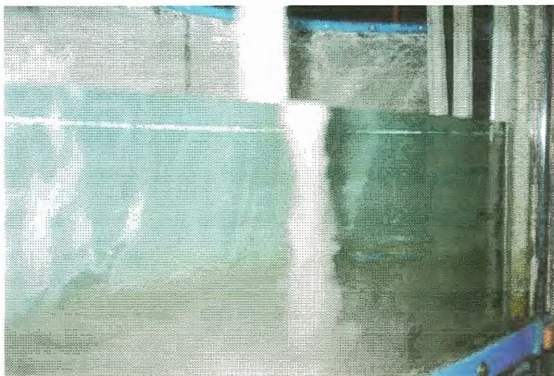
FIGURA 29 - Lançamento de areia para preenchimento do modelo experimental
