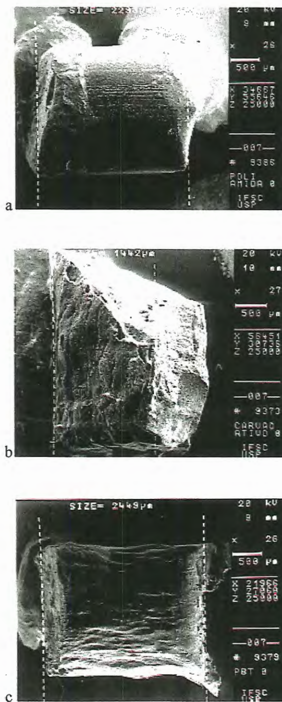
Figura 4.1: Fotografias das Partículas Amostradas de Poliamida (a), CAG (b) e PBT (c).
