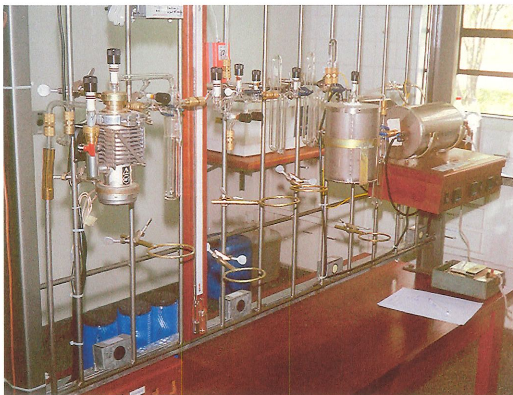
FIGURA 8 - Linha de combustão de amostras orgânicas para análises de razão isotópica de ^{13}\text{C}/^{12}\text{C} , por espectrometria de massas do CENA/USP
