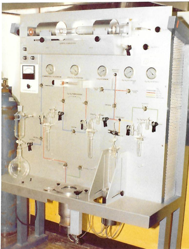
FIGURA 9 - Linha de Combustão e síntese benzênica de amostras destinadas a datação por ^{14}\text{C} do Laboratório do CENA/USP
