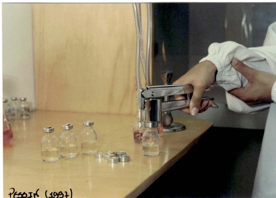
Figura 21 - Lacreador de frascos tipo “antibiótico” - fixação do lacre de alumínio nos frascos.
