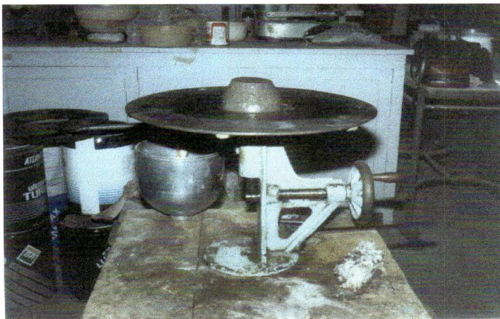
FIGURA 5.8- Aspecto da determinação da consistência da mistura
