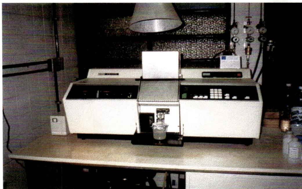
FIGURA 5.16- Espectrofotômetro de absorção atômica utilizado no trabalho (Intralab AA-1275)
