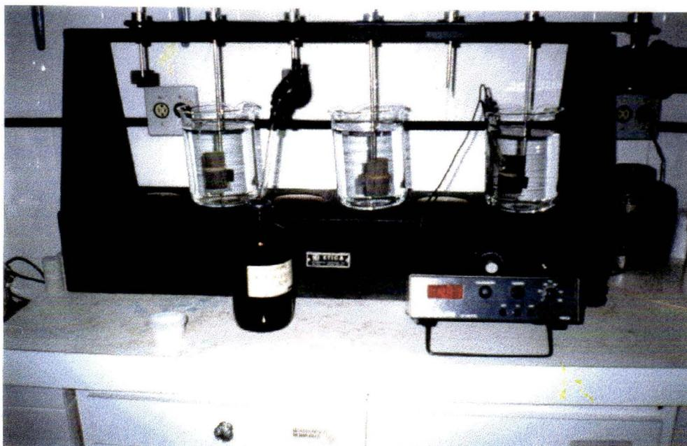
FIGURA 5.13- Corpos-de-prova submetidos ao ensaio de lixiviação
