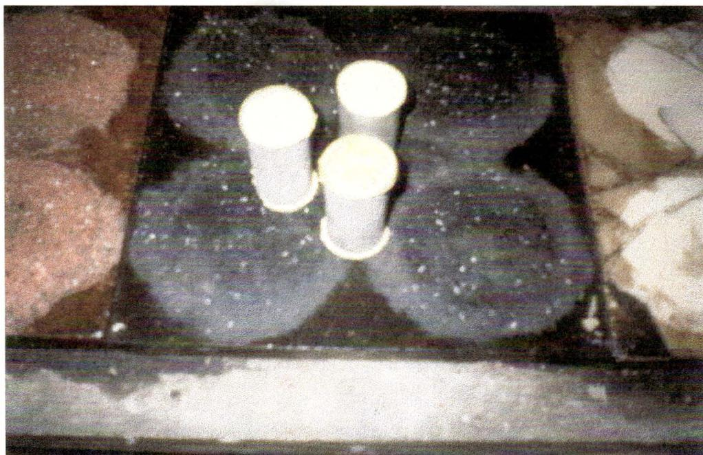
FIGURA 5.11- Corpos-de-prova capeados para ensaio de resistência mecânica
