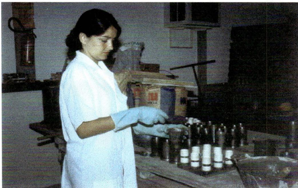
FIGURA 5.9- Aspecto da moldagem dos corpos-de-prova
