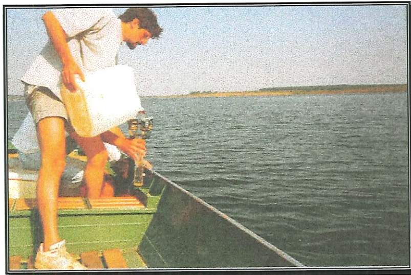
FIGURA - 7 : Fotografia demonstrando o procedimento inicial para coleta de sedimento recente por meio de armadilha de sedimentação.
