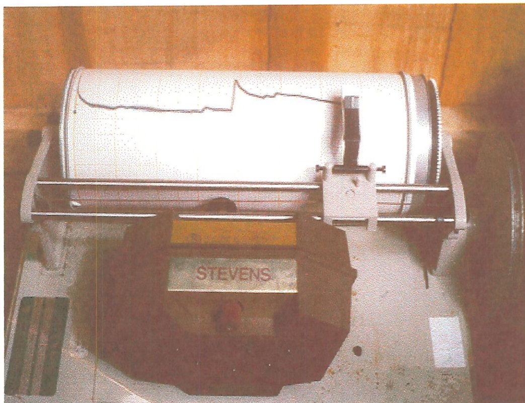
FIGURA 13 - Detalhe do limnógrafo instalado.
