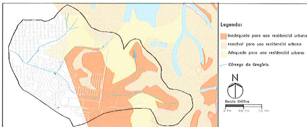
Figura 7.21: Mapeamento Geotécnico da área de expansão urbana de São Carlos Fonte: PMCS/SMH DU (2004)
