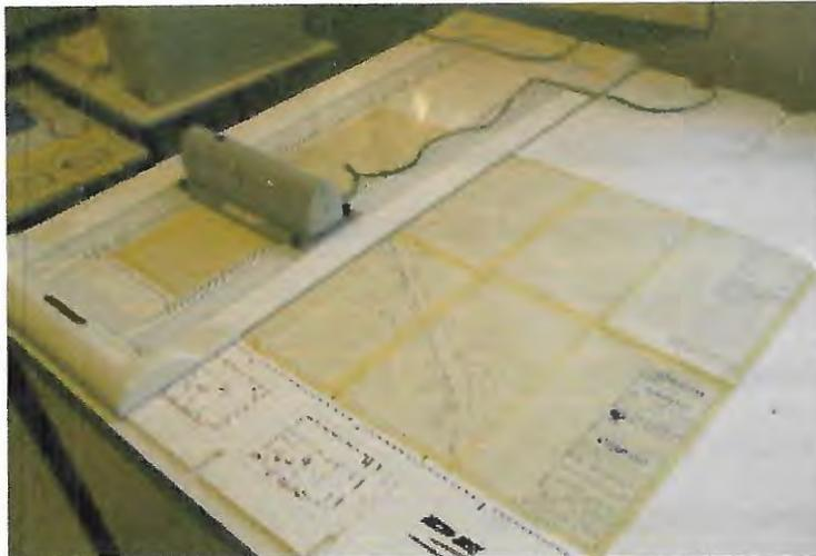
Figura 20: Carta batimétrica sendo captada pelo scanner. (Fonte: O autor)
