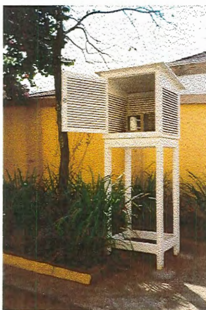
FIGURA 15 - Abrigo climatológico instalado no Colégio São Carlos
