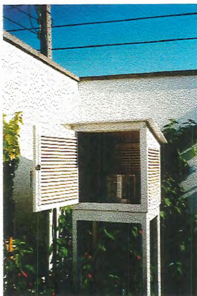
FIGURA 17 - Abrigo climatológico instalado no SESC
