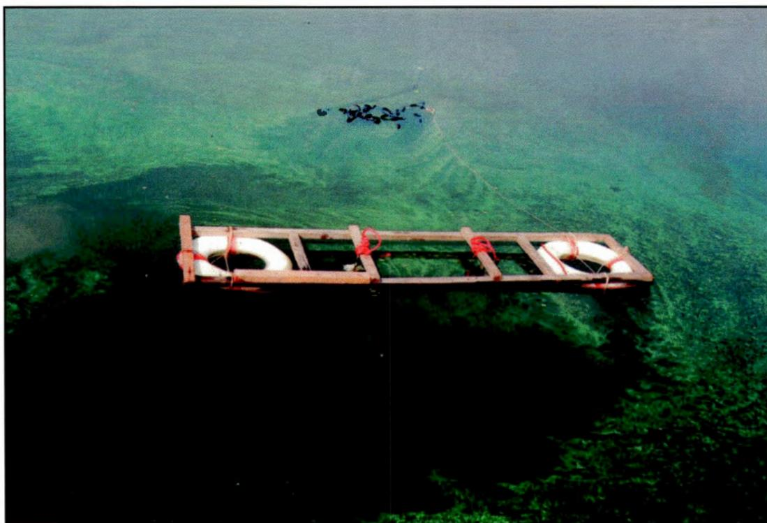
**FIGURA 21** – “Nata” de algas na superfície da coluna d’água, próxima ao equipamento de incubação para o experimento de produção primária no Reservatório de Salto Grande.
