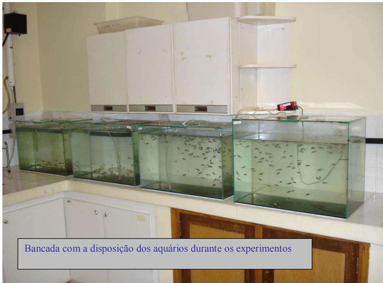
**Figura 33** – Aquários experimentais com os peixes *D. rerio* e *H. eques*. Relação máxima de massa/volume de  $1 \text{ g.L}^{-1}$  (*D. rerio*) e  $1,3 \text{ g.L}^{-1}$  (*H. eques*).
