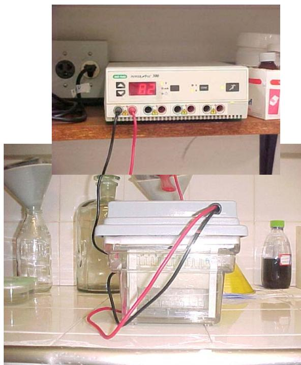
**Figura 18** - Fonte indutora de tensão ligada a uma das cubas eletrolíticas onde são efetuadas as corridas eletroforéticas.
