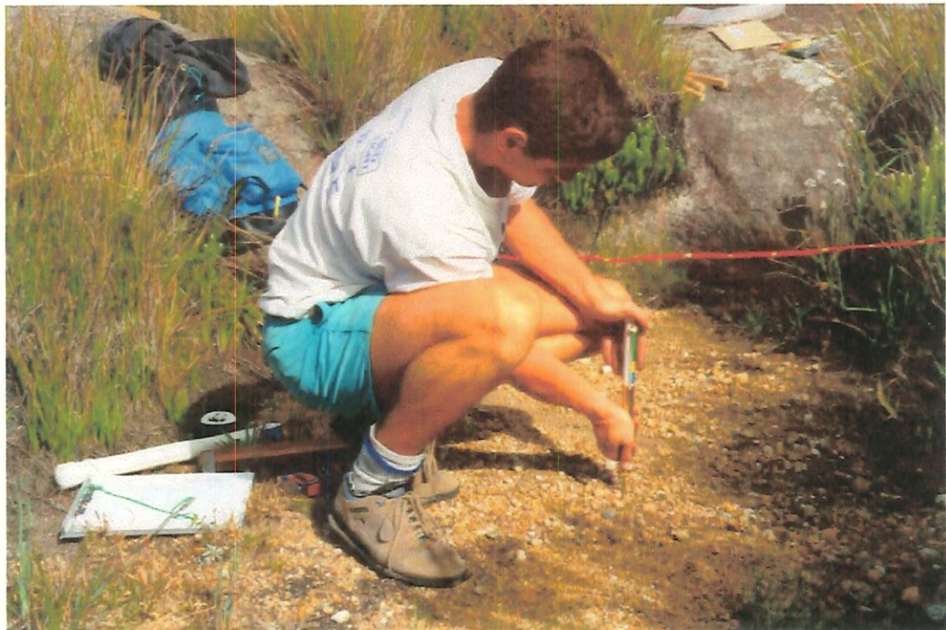
FIGURA 14 - Uso do Penetrômetro Lang para avaliação do grau de compactação da superfície do solo.
