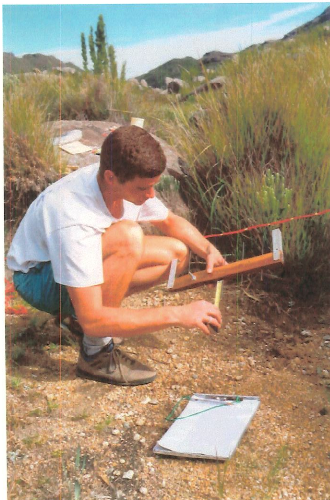
a) Avaliação da rugosidade da superfície do solo
