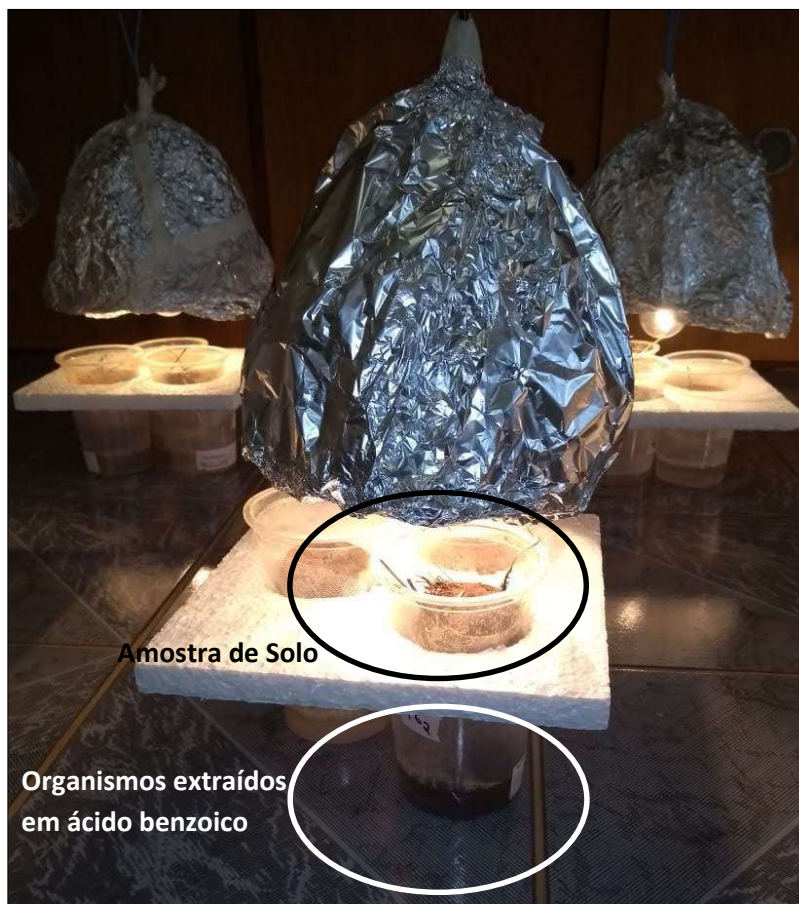
Figura 4 - Sistema de extração de organismos edáficos de mesofauna: aparato adaptado de Tulgreen
