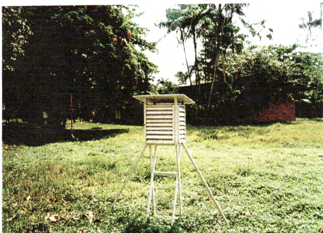
FIGURA 04 - Abrigo meteorológico utilizado nas três fases experimentais
