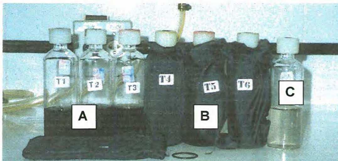
**Figura 16.** Frascos reatores utilizados no decaimento do TCE: **A** - reatores sem o saco de pano preto; **B** - reatores coberto com os sacos pretos e **C** - reator de controle químico (abiótico).
