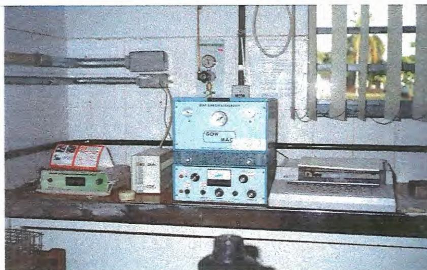
**Figura 10.** Cromatógrafo a gás, para a determinação da composição concentração do metano (Gow-Mac).
