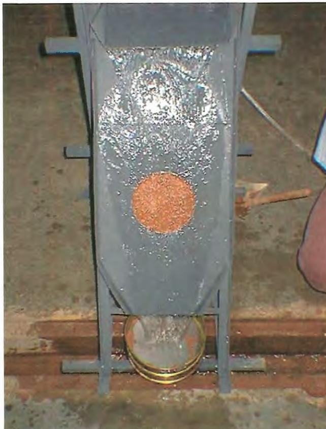
**FIGURA 8** Ensaio e coleta de material erodido no ensaio de Inderbitzen
