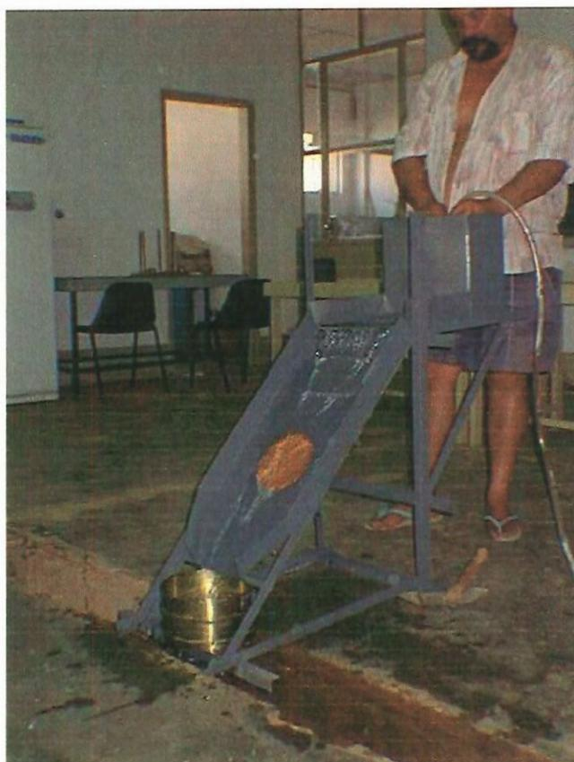
**FIGURA 7** Ensaio de Erodibilidade sendo executado no aparelho de Inderbitzen
