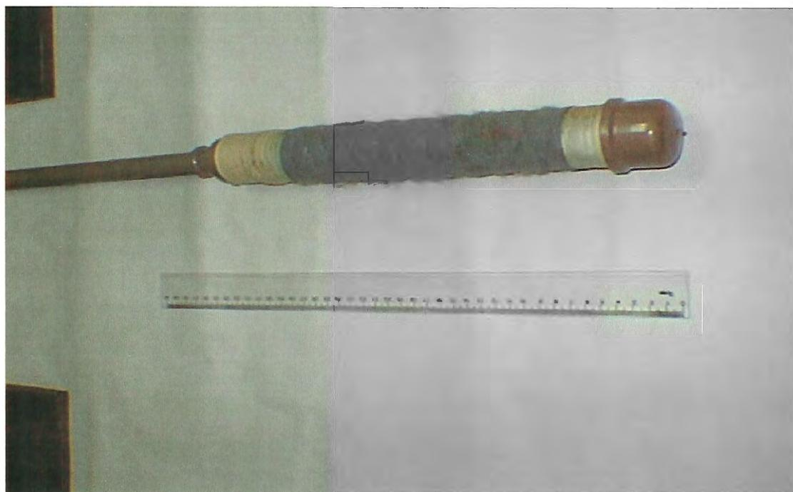
**FIGURA 11** Ponteira padrão dos piezômetros confeccionados
