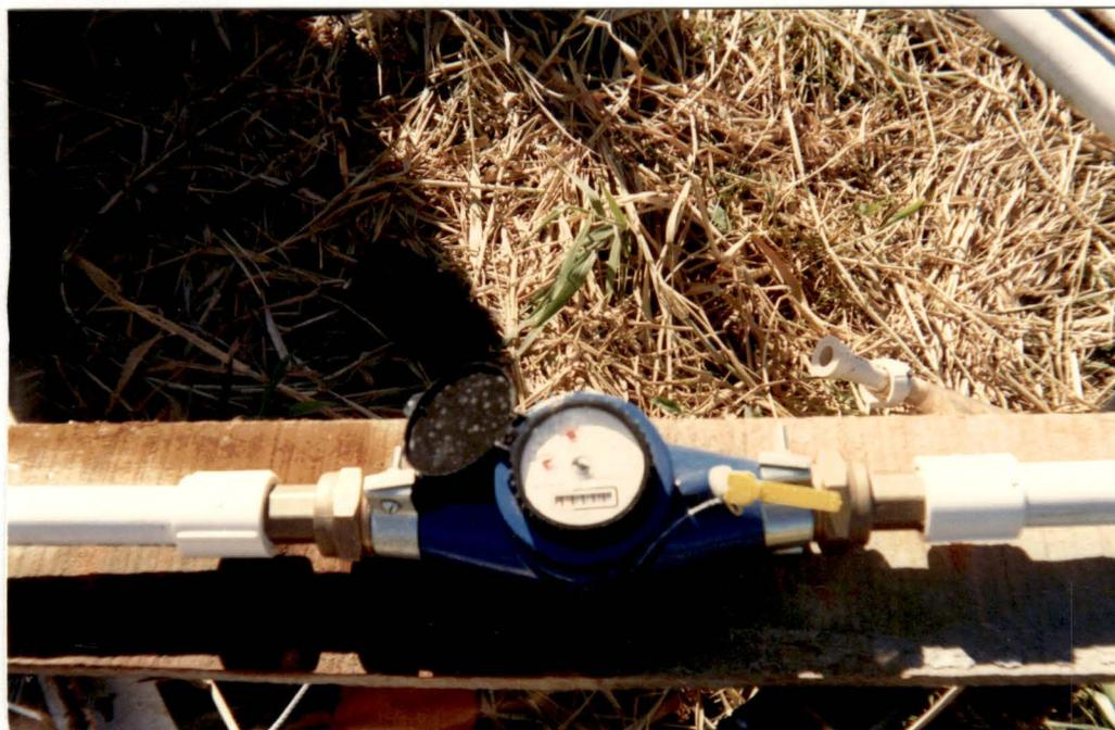
Figura 23: Hidrômetro utilizado nos testes de bombeamento.
