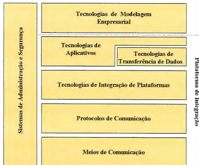
FIGURA 5 – Modelo de referência para infra-estruturas de informação
