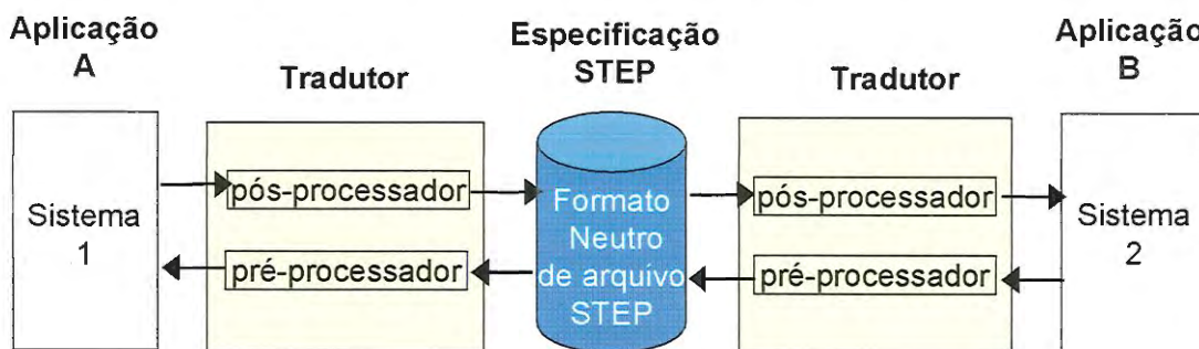
FIGURA 18 – Princípio de troca de dados do STEP
