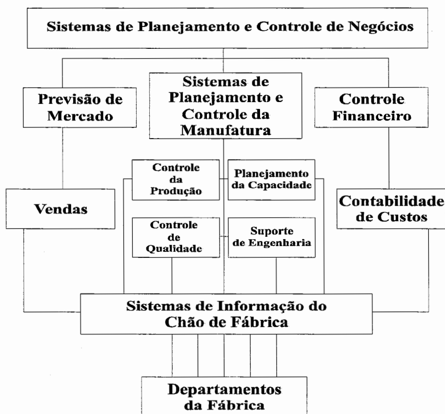
Figura 2.2: Hierarquia de um sistema de informação de chão-de-fábrica integrado
