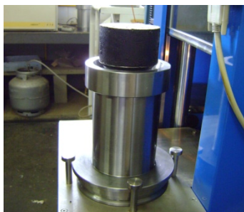
(g) Extração do corpo-de-prova após compactação e retirada do papel filtro
