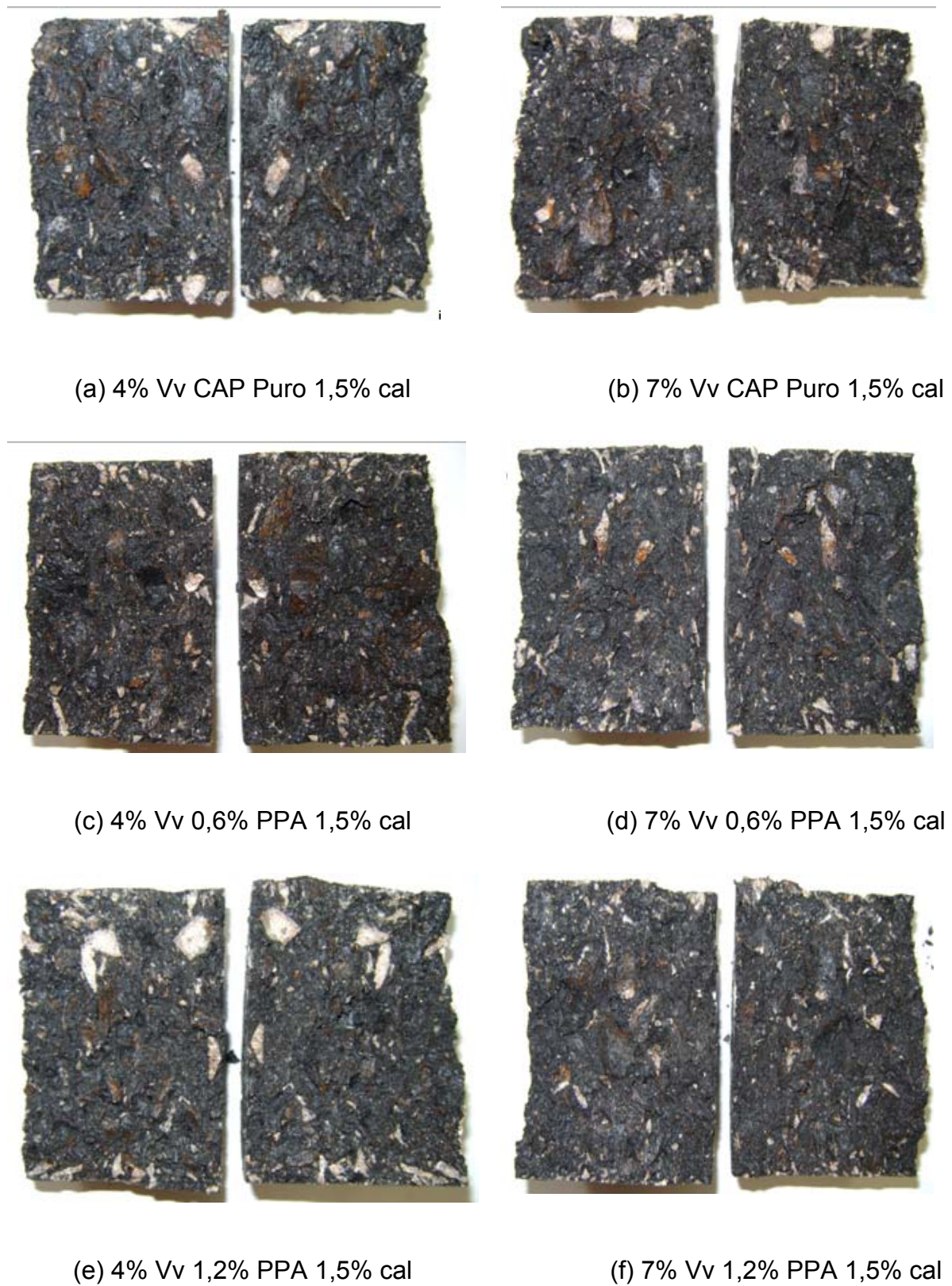
Figura 4.26. Superfícies de ruptura de corpos-de-prova com 1,5% de cal com CAP Puro para 4% (a) e 7% (b) de V_v , 0,6% de PPA para 4% (c) e 7% (d) de V_v e com 1,2% de PPA para 4% (e) e 7% (f) de V_v
