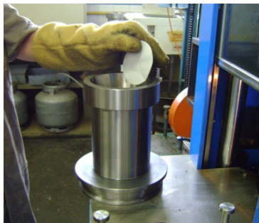
(c) Colocação do papel filtro no fundo do molde
