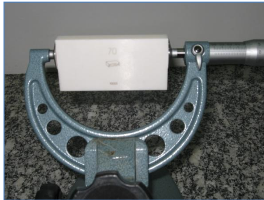
Figura 5.19 – Ajuste de Medida do Micrômetro com Bloco Padrão
