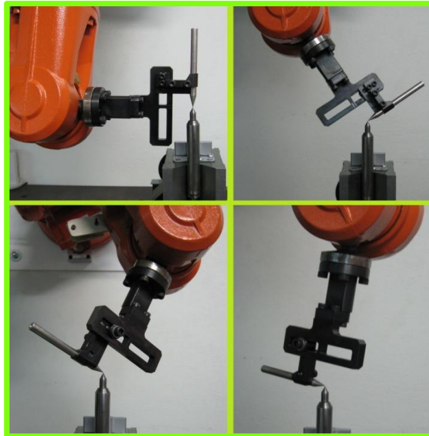
Figura 5.16– Movimentação do manipulador em quatro orientações diferentes
