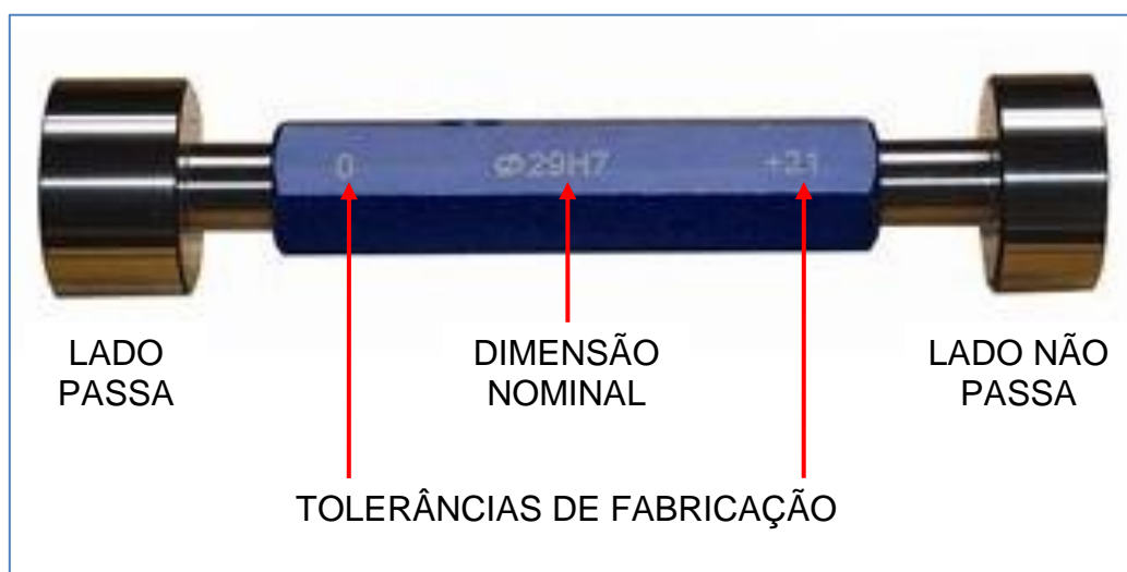
Figura 2.20 – Calibrador Tampão do Tipo Passa/Não passa
