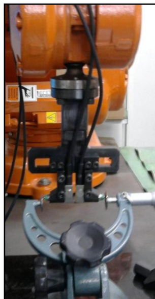
Figura 5.20 – Posicionamento das Faces Internas do Micrômetro com os LVDT’s
