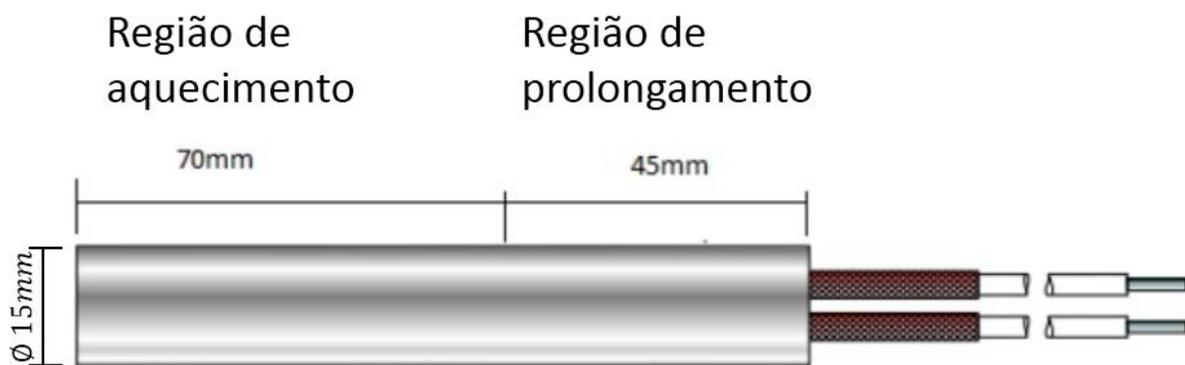
**Figura 3.2 - Resistência elétrica do tipo cartucho de 300W.**
