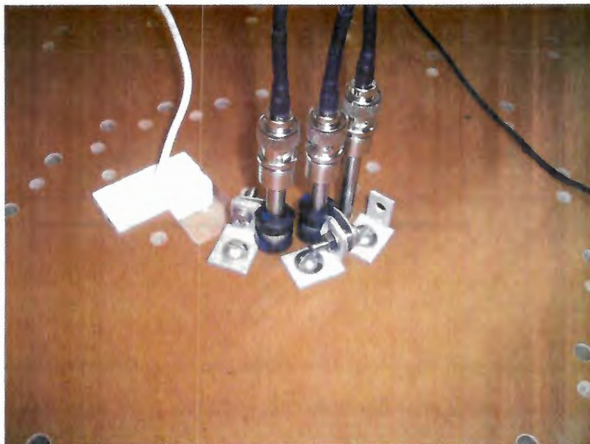
Figura 6.1: Vista em detalhe da fixação dos microfones à placa de Ambartex da antena de beamforming do túnel de vento LAE-1.
