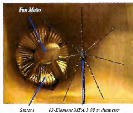
Figura 2.9: Antena de beamforming montada a 9.5 metros a jusante do ventilador do túnel de vento da universidade Virginia Tech . Figura retirada de (CAMARGO et al., 2007).
