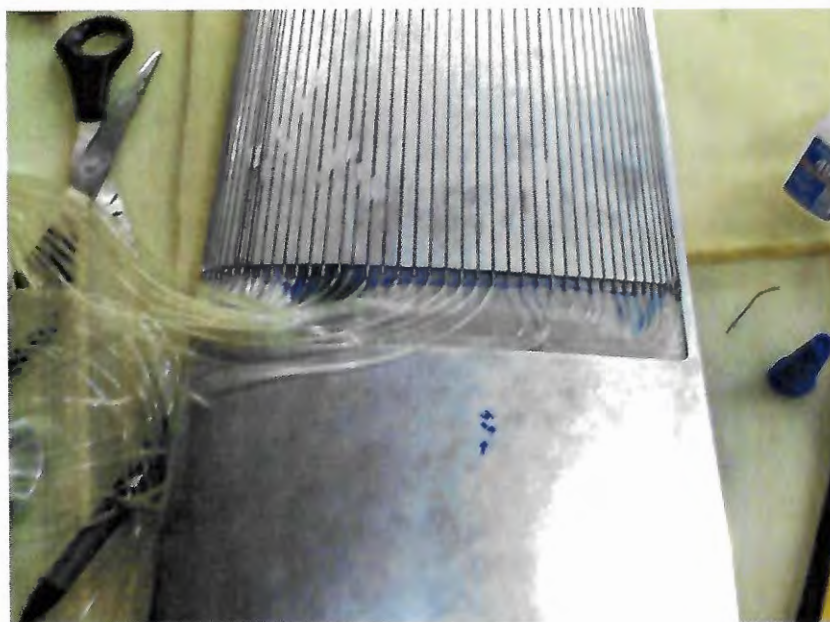
Figura 3.8: Fotografia do aerofólio NACA-0012 2D, durante a instrumentação, utilizado nos ensaios.
