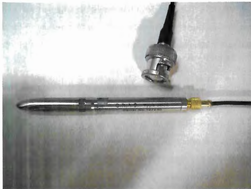
Figura 3.2: Microfone utilizado na medição de ruído de fundo do túnel de vento LAE-1.
