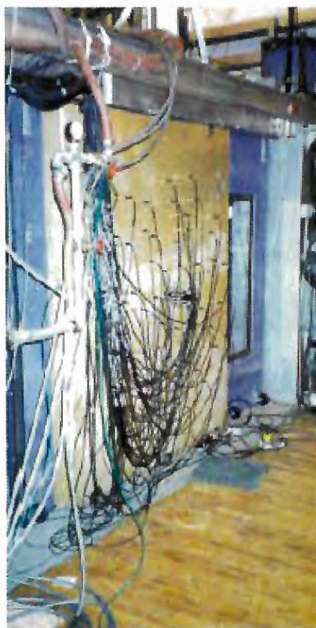
Figura 2.14: Vista traseira da placa de microfones instalada no túnel NASA 7- por 10 pés. Figura retirada de (STORMS et al., 1998).
