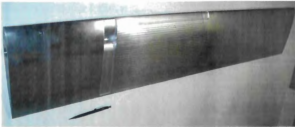
Figura 3.7: Fotografia do aerofólio NACA-0012 2D, antes da instrumentação, utilizado nos ensaios.
