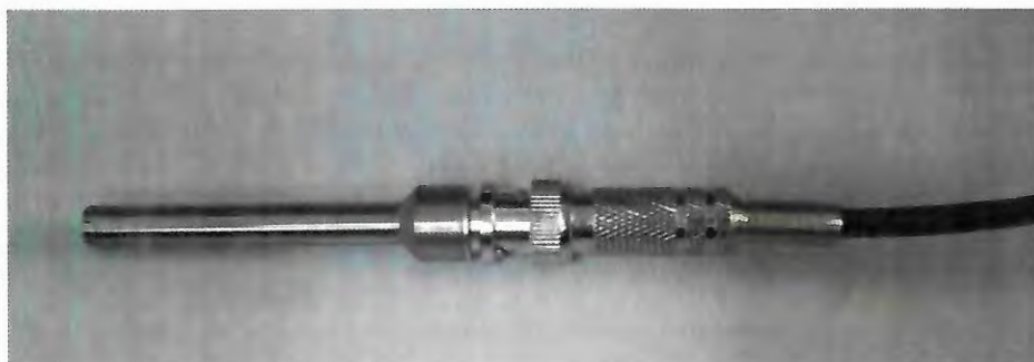
Figura 3.3: Microfone GRAS do tipo 40PH utilizado na aquisição de ruído de fundo do túnel.
