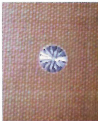
Figura 6.2: Vista em detalhe da superfície do microfone faceando a placa de Ambartex.
