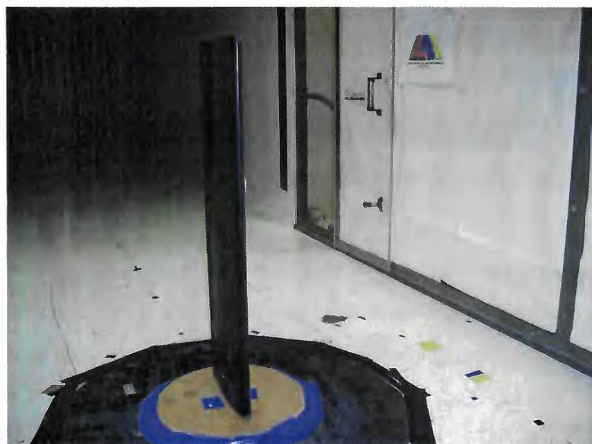
Figura 3.5: Modelo do aerofólio 3D GA(W)-1 adotado nos ensaios de beamforming .
