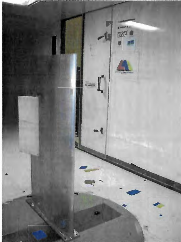
Figura 3.6: Aerofólio NACA-0012 3D com flape adotado nos ensaios.
