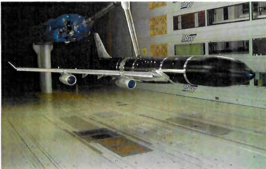
Figura 2.16: Modelo da aeronave Airbus A-340 colocado na câmara de ensaios do túnel de vento da DNW. Figura retirada de (OERLEMANS; SIJTSMA, 2004).
