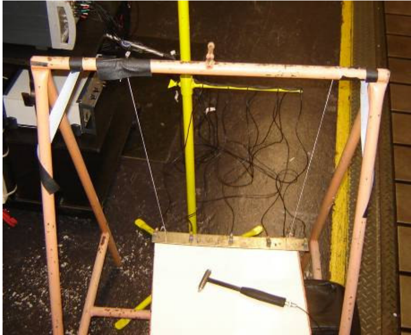
Figura 4.5: Estrutura metálica de sustentação.
