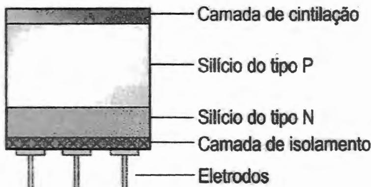
**Figura 13: Corte transversal de um elemento da matriz semicondutora. Fonte (WHAITES, 2011).**
