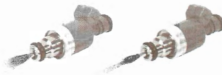
Figura 114. Jato de combustível utilizando bico cônico de um orifício
