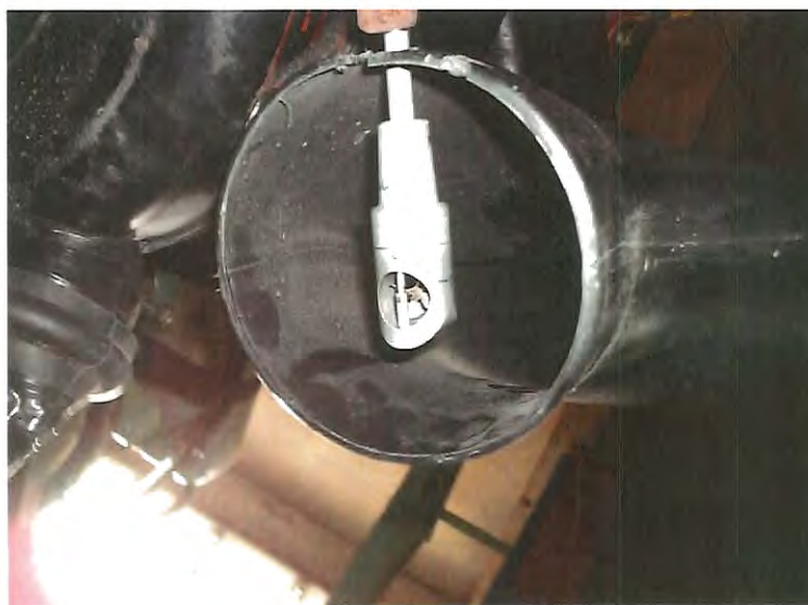
Figura 43. Anemômetro colocado no filtro de ar do motor
