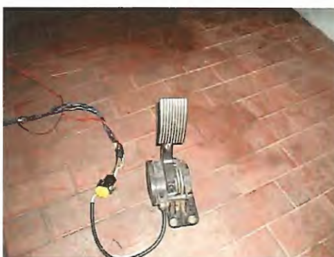
Figura 63. Ligação em paralelo no pedal do acelerador para recebimento de sinal de posição
