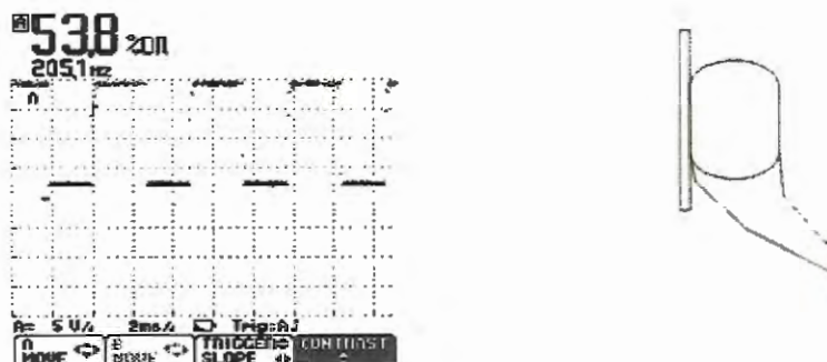
Figura 106. Sinal elétrico emitido pelo pedal do acelerador na posição de plena carga
