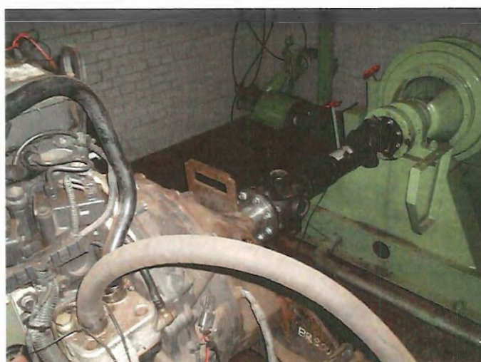
Figura 41. Dinamômetro acoplado ao motor MB OM 924 LA
