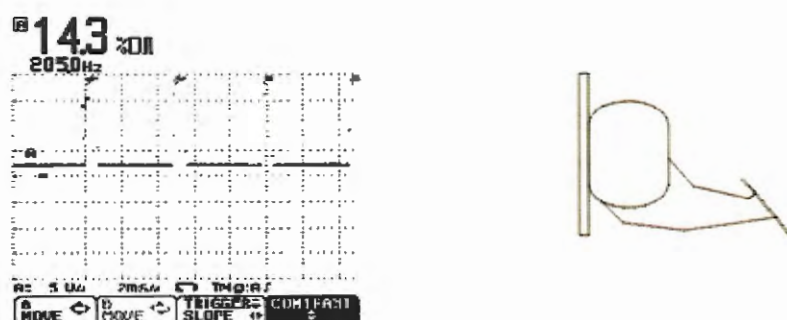
Figura 105. Sinal elétrico emitido pelo pedal do acelerador na posição de repouso (marcha lenta).
