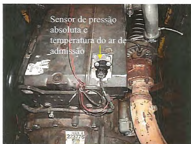
Figura 62. Sensor de pressão e temperatura do ar admitido pelo motor
