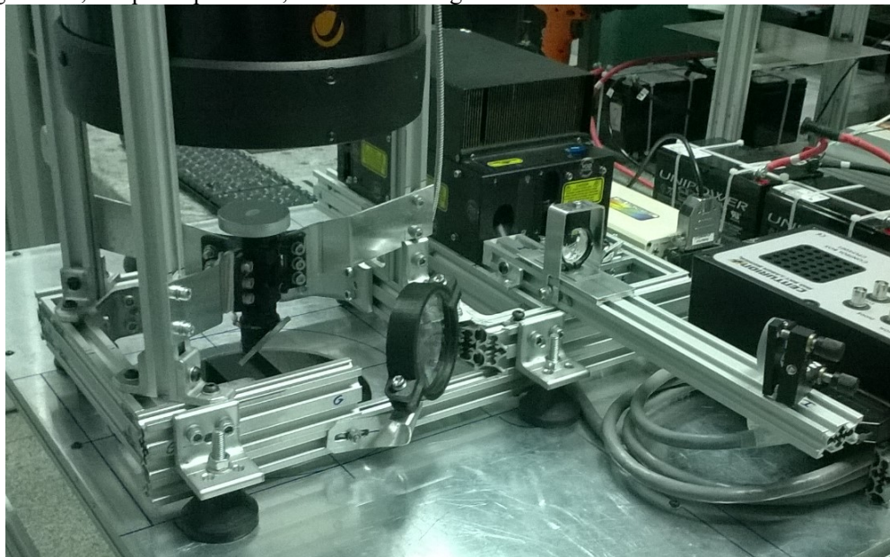
Figura 3.7.3. Fotografia do suporte mecânico com os elementos ópticos dos sistemas de coleta e disparo montados. Observam-se no centro esquerda o suporte projetado para a montagem do espelho plano L2 e do espelho secundário Es, assim como a parte inferior do telescópio, o laser, a lente divergente L1, o espelho plano E1, e a lente convergente L2.
