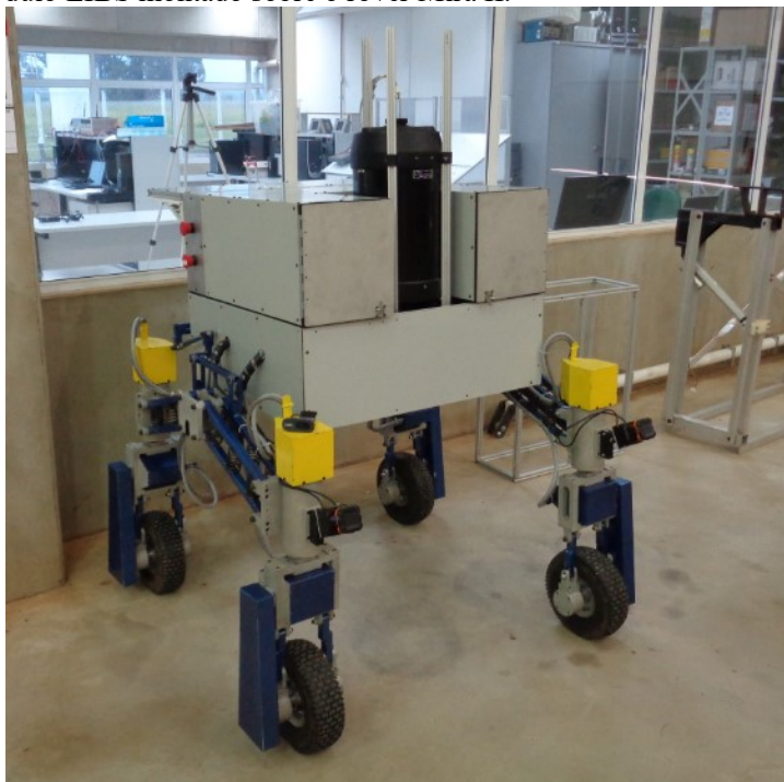
Figura 4.11. O Módulo LIBS montado sobre o rover Mirã II.
