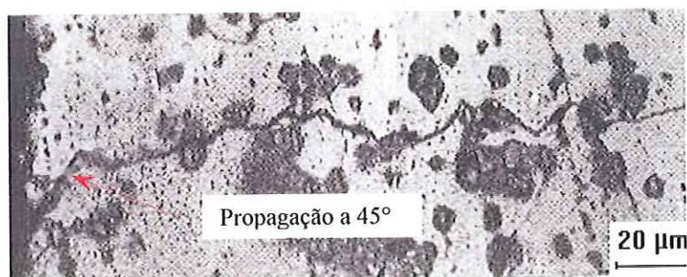
**Figura 3.2** – Micrografia mostrando o estágio I de propagação de trinca por fadiga a  $45^\circ$  em relação à direção do carregamento aplicado na liga de alumínio RR58.(Spinelli, D. - 1978)
