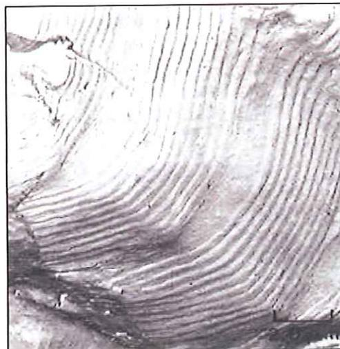
**Figura 3.7** – Estriamento na superfície de fratura por fadiga em um aço de baixo carbono (8620) [Donald, 2000].
