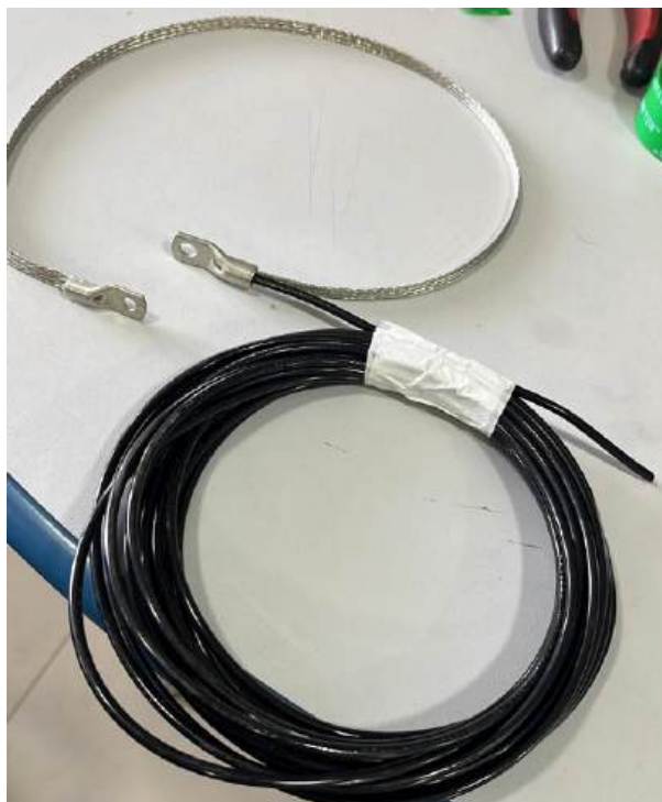
Figura 80 – Detalhe do cabo de derivação para a medição da corrente de fuga de correntes de fuga em sistemas de alta tensão, com foco nos sistemas de isolamento, como é o caso deste projeto.
