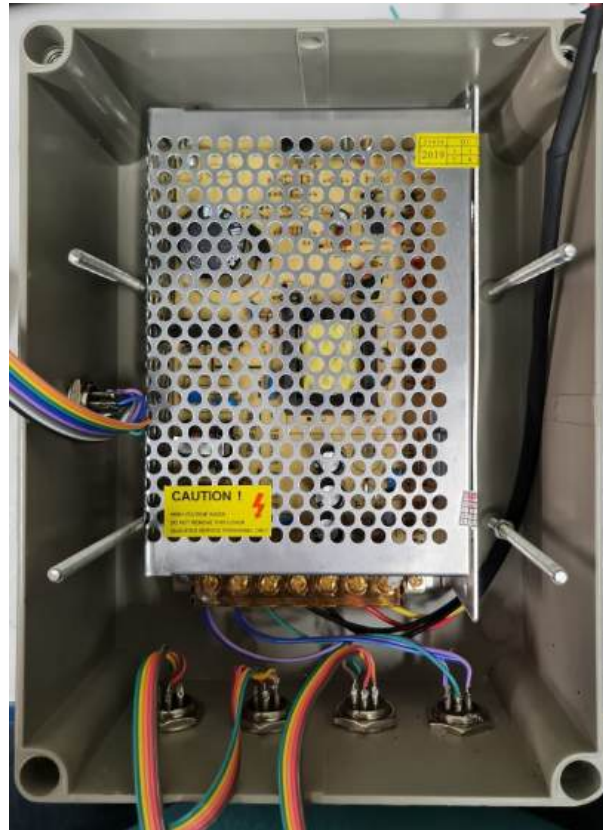
Figura 92 – Montagem da fonte chaveada utilizada
