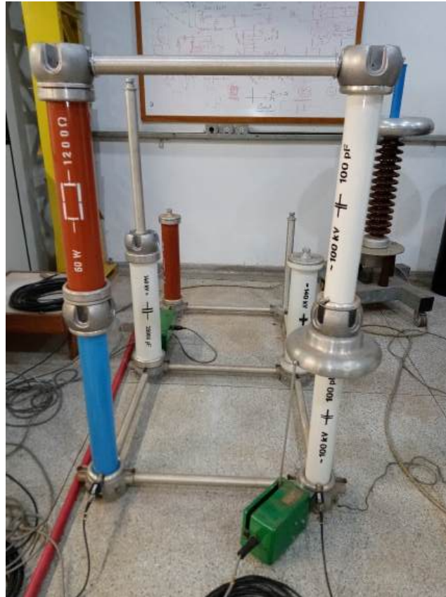
Figura 39 – Circuito CA utilizado para calibração
