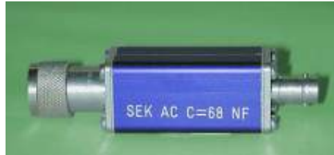
Figura 24 – Parte secundária do capacitor de medição
