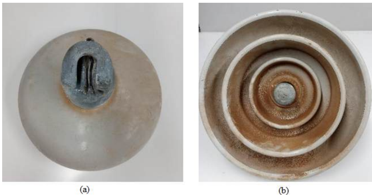
Figura 2 – Isoladores de suspensão - (a) Vista da parte superior; (b) Vista da parte inferior
