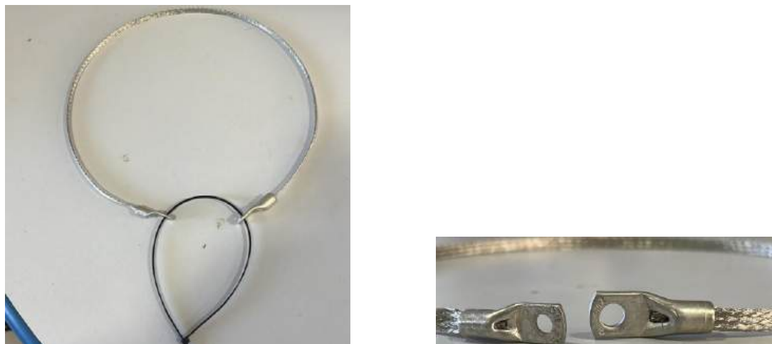
(a) Anel de cordoalha para medição da corrente de fuga (b) Detalhe do anel de cordoalha para a medição da corrente de fuga.
