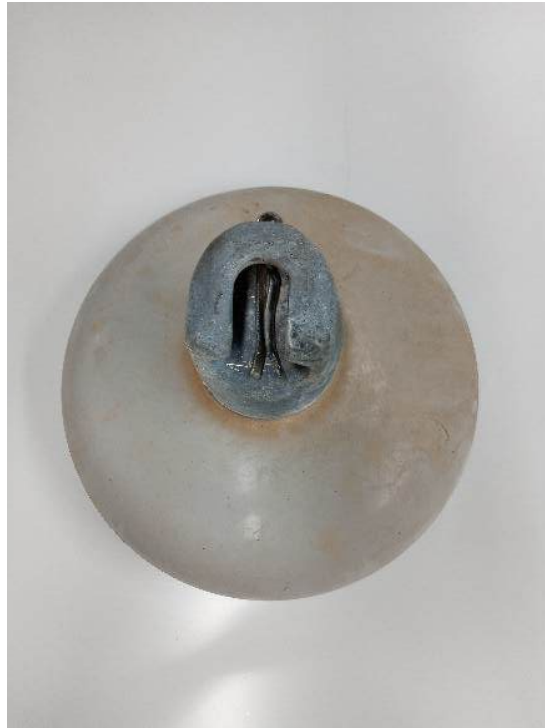
Figura 42 – Isolador nº 24 da cadeia de isoladores contaminado naturalmente – Parte superior
