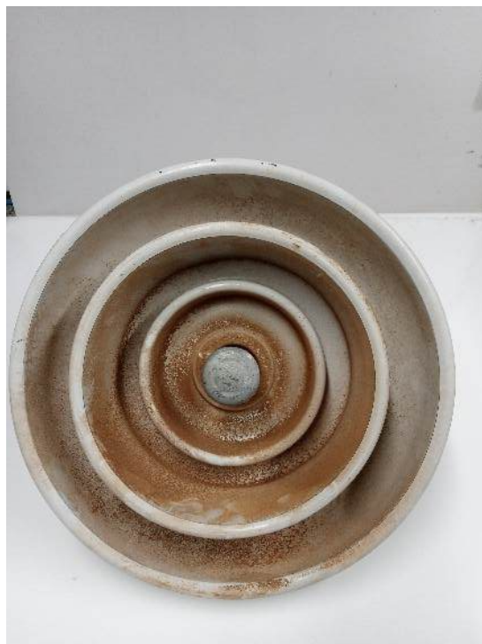
Figura 43 – Isolador nº 24 da cadeia de isoladores contaminado naturalmente – Parte inferior
