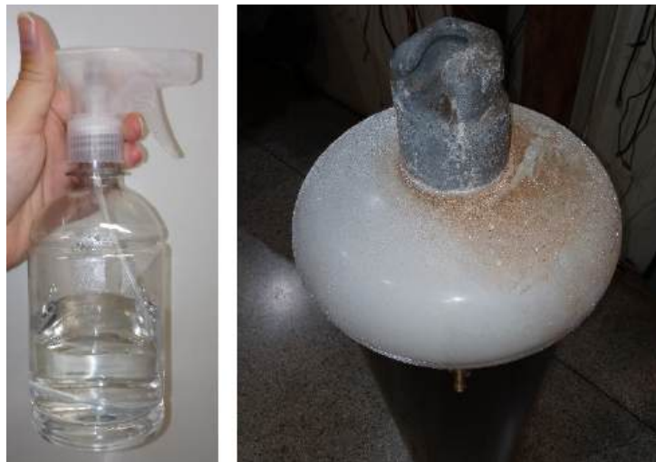
Figura 47 – Borrifador utilizado no experimento e superfície do isolador 24 umidificada
