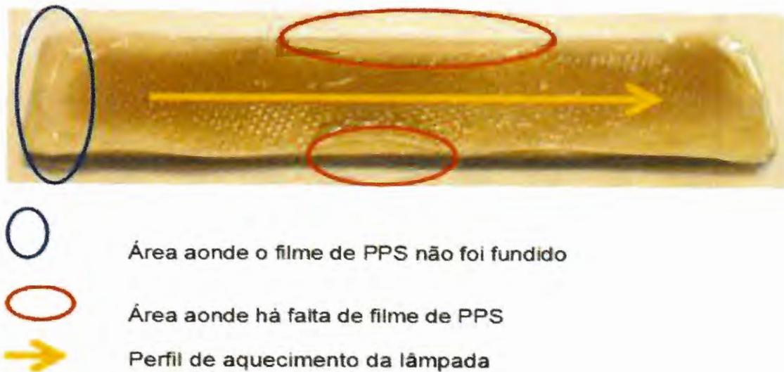
**Figura 36:** Laminado PPS-C-V, soldado pelo processo de radiação infravermelha.
