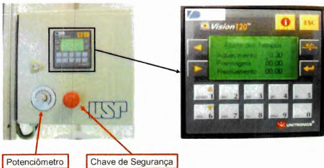
**Figura 16:** Painel de Elétrico do dispositivo de soldagem.
