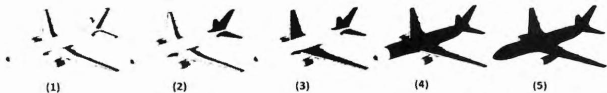
**Figura 3:** Uso progressivo de materiais compósitos em estruturas aeronáuticas de aeronaves comerciais (adaptado de NIU, 1992).
