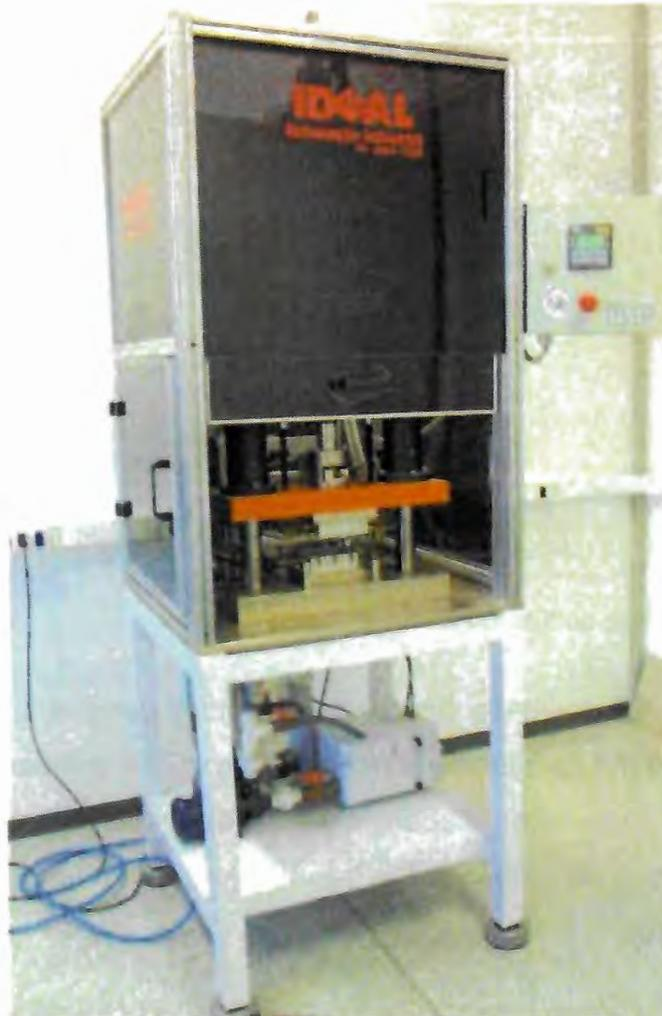
**Figura 15:** Dispositivo de soldagem por radiação infravermelha.
