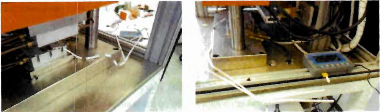
**Figura 29:** Termômetro digital de quatro canais – MT1044.
