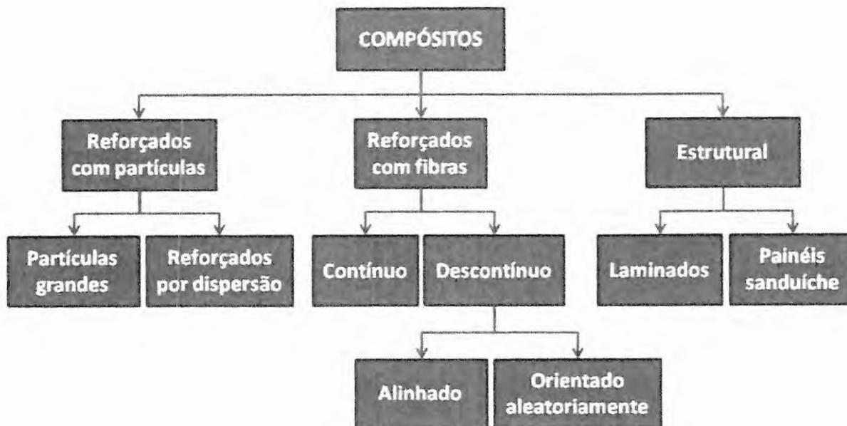
**Figura 2:** Classificação dos tipos de compósitos (adaptado de CALLISTER, 2006).
