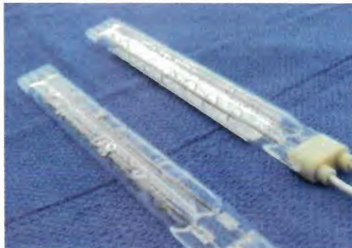
**Figura 8:** Esquemático de lâmpadas de quartzo com altas intensidades (HERAEUS, 2015).
