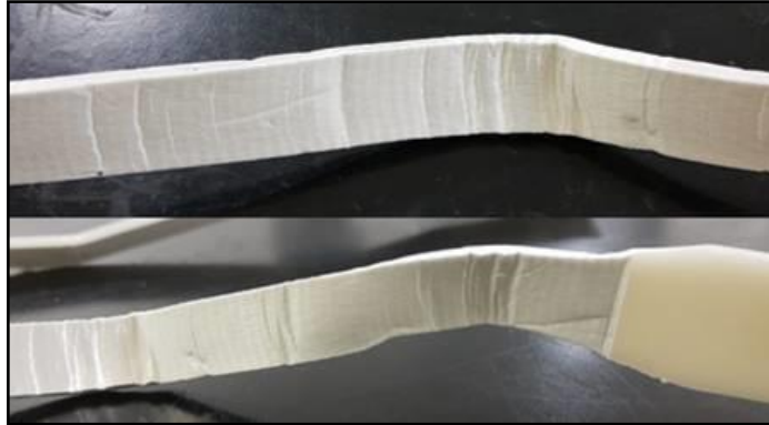
Figura 40 – Imagens de corpos de prova das amostras de biocompósitos com ácido cítrico, pós ensaio de tração.
