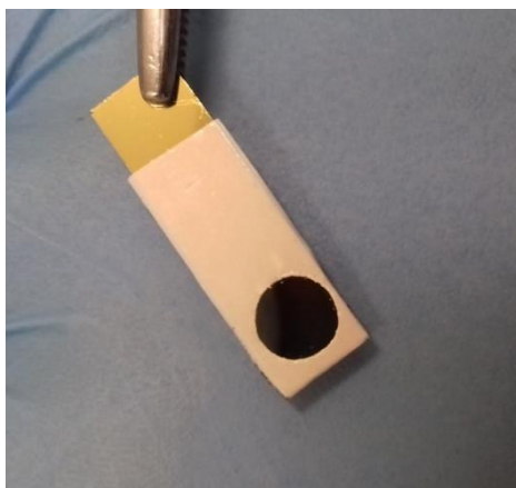
Figura 4: Eletrodo de ouro com área delimitada
