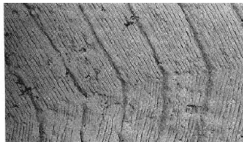
Figura 2 - Estrias de fadiga correspondentes à variação da amplitude de carregamento [37].
