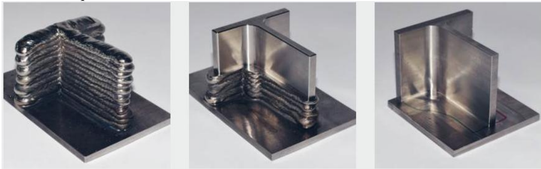
Figura 14 – Peça fabricada a partir de um equipamento de soldagem GMAW desenvolvido pela empresa Fronius e que utiliza a técnica de transferência CMT.
