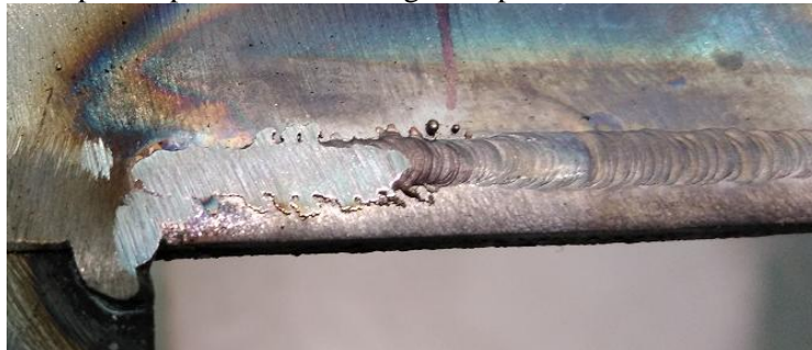
Figura 74 – Condição do passe após desbaste na região depositada.
