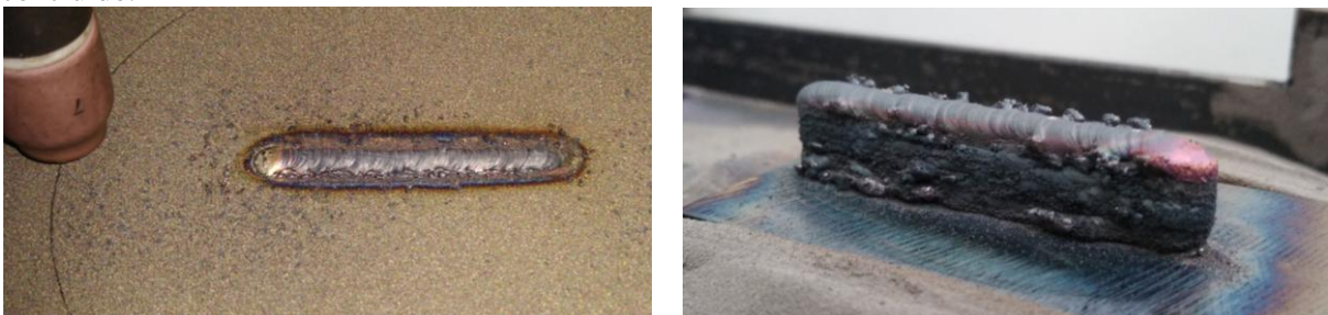
Figura 82 – Fases do processo de deposição do CDPP-02: a) Finalização de um passe e b) depósito concluído.
