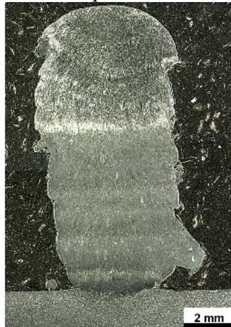
Figura 78 – Corte transversal do CDPP-01. Ataque: Nital 2%.
