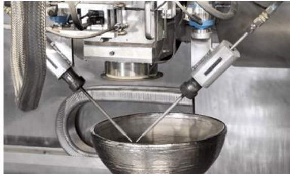
Figura 12 – EBAM desenvolvido pela empresa SCIAKY Inc.
