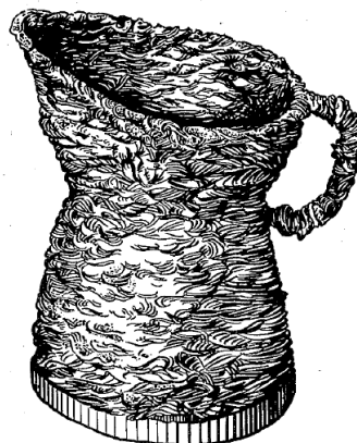
Figura 13 – Jarro obtido por Ralph Baker em 1920 pela deposição, camada sobre camada, utilizando arame metálico e arco elétrico.
