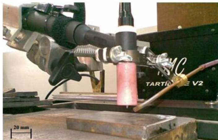
Figura 44 – Primeiro protótipo desenvolvido por Moselli (2013) para revestimento superficial.
