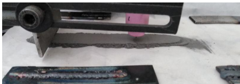
Figura 55 – Nivelamento da camada de pó.
