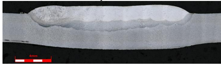
Figura 95 Secção transversal do CDPPR-1. Ataque Nital 5%.
