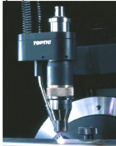
Figura 38 – Processo TOPTIG em operação.
