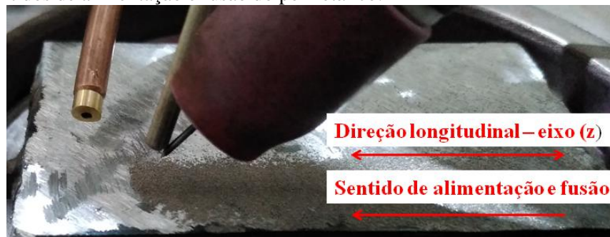
Figura 68 – Sentidos de alimentação e fusão do pó metálico.
