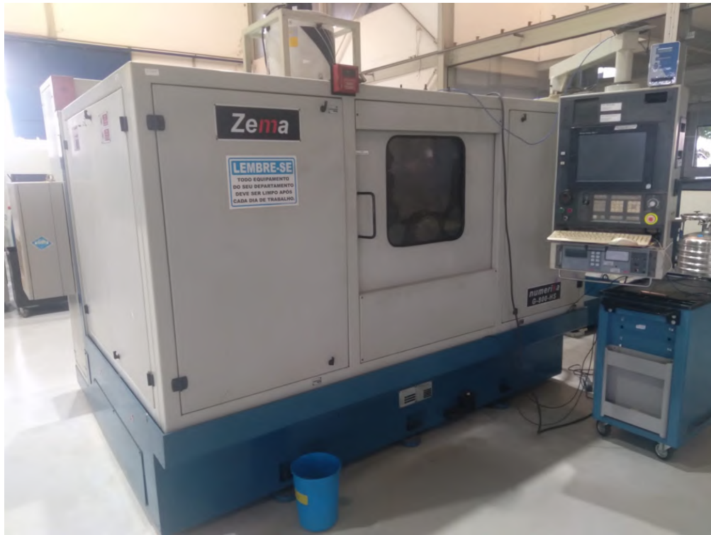
Figura 7 – Retífica cilíndrica Zema modelo Numerika G-800-HS.
