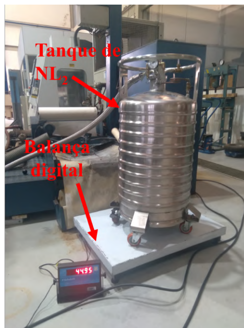
Figura 10 – Tanque de armazenamento/fornecimento do fluido criogênico e balança digital para medição de fluxo mássico durante os processos.
