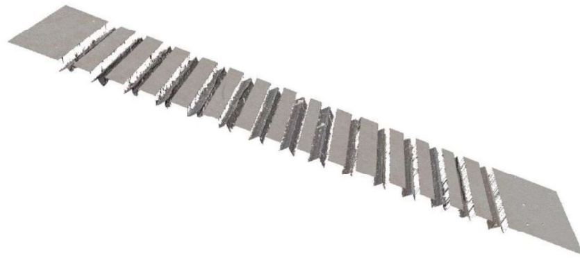
Figura 3.8 – a) Imagem dos microcanais b) Perfil da seção transversal.
