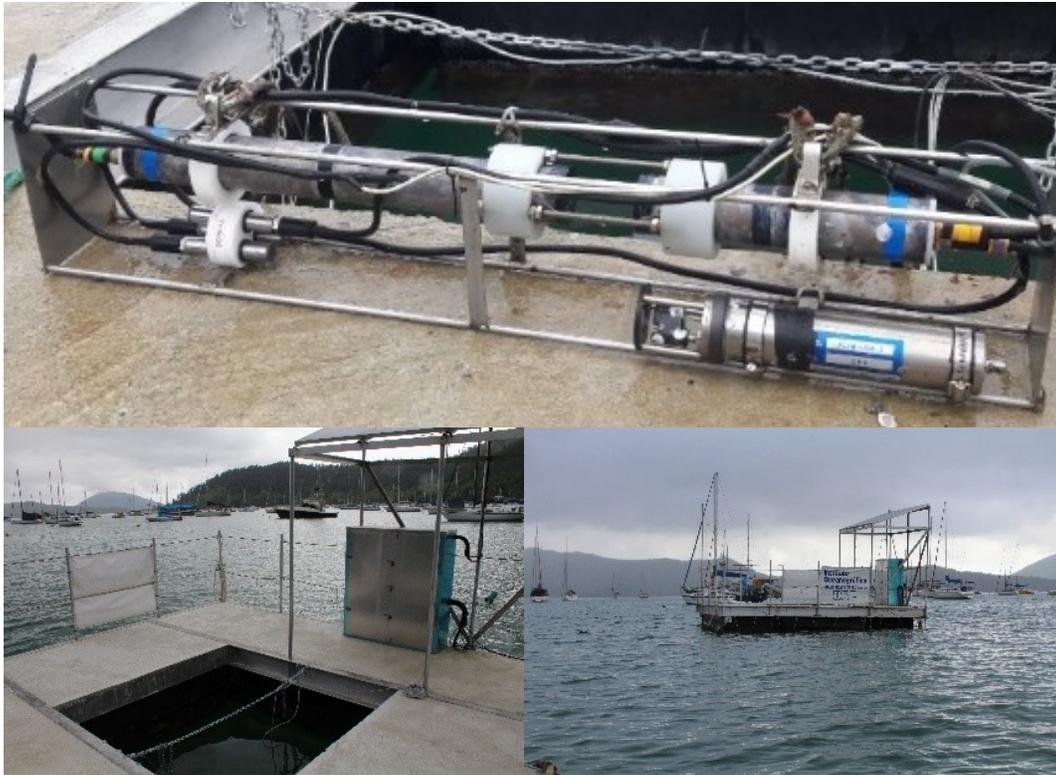
**Figura 21: Equipamento de imagem com sensores acoplados, fixados em uma gaiola presa à plataforma flutuante. Ao fundo se vê o armário sobre o flutuante, onde foram instalados o computador e o controlador eletrônico do sistema, mostrados na Figura 22.**
