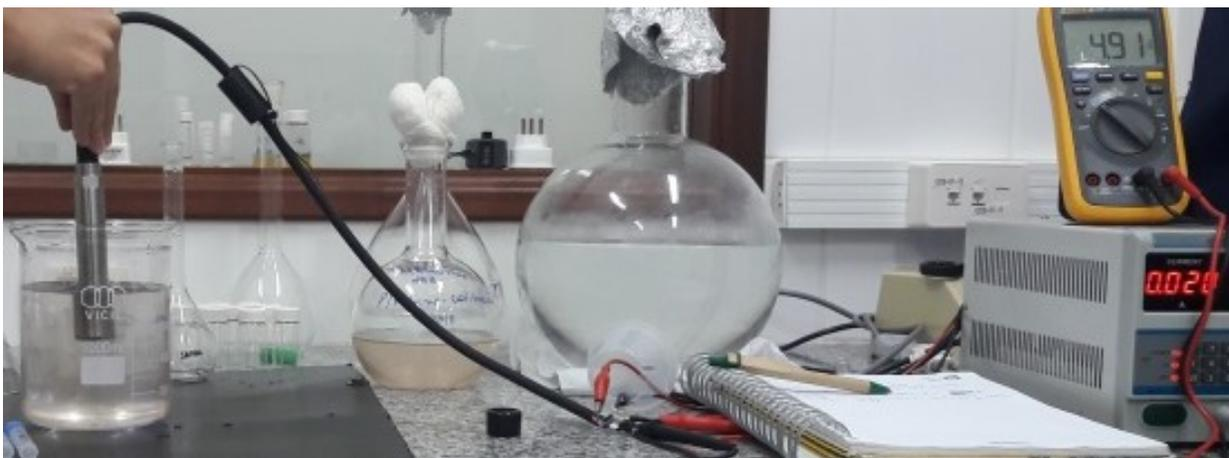
Figura 15: Calibração do sensor Cyclops-7 para obtenção da equação de correção da Clorofila.
