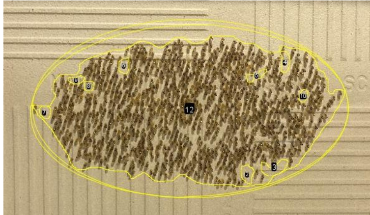
Figura 8 Medição da área, dos espaços vazios e do círculo da mesma massa da Figura 6.
