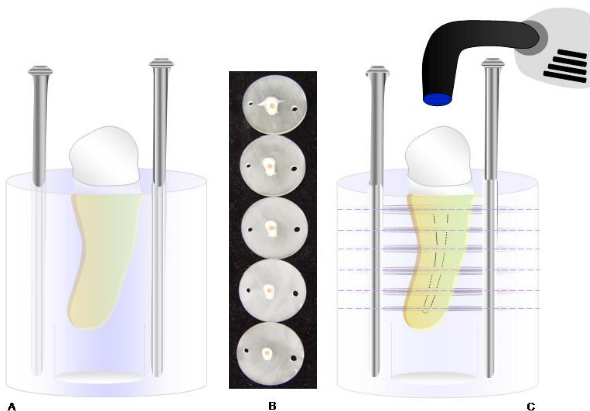
Figura 4.11 - (A) - Pré-molar inferior embutido em resina de poliéster; (B) – Bloco de resina seccionado em fatias de 2.0 mm de espessura; (C) – Fatias remontadas após confecção dos cps e fotoativação do cimento
