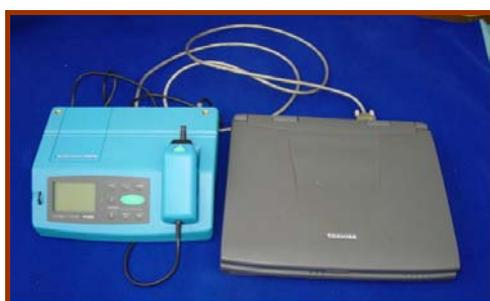
FIGURA 32- Rugosímetro acoplado ao microcomputador.
