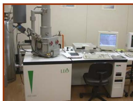
FIGURA 37- Microscópio eletrônico de varredura.
