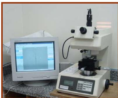
FIGURA 30- Microdurômetro acoplado ao computador.
